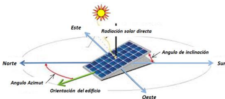
Figura 10.8. Representación del ángulo Azimut y ángulo de inclinación de las placas solares. Fuente: Elaboración propia adaptado de Sunfields Europe (s/f)
