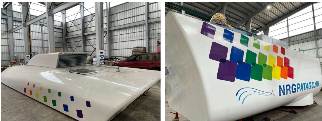
Figura 15. Góndola del aerogenerador NRG P82 1,5MW. Fuente: propia
