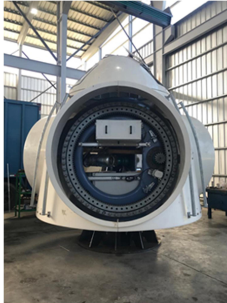
Figura 14. Buje del aerogenerador NRG P82 1,5MW. Fuente: propia
