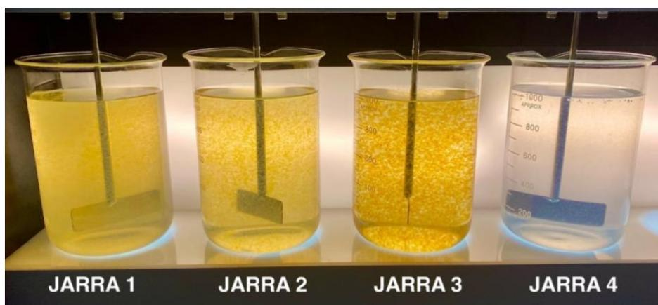
Figura 22. Jarras con distintas características en el proceso de coagulación. Elaboración propia (2023)
