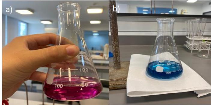
Figura 20. Muestra para cuantificar dureza: a) sin titular, b) titulada
