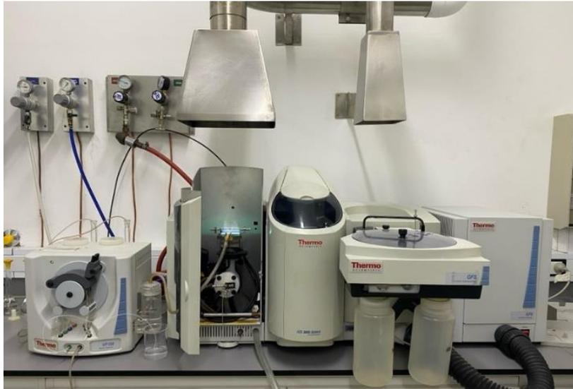
Figura 14. Equipo Thermo Scientific Modelo iCEE 3000 para medición de arsénico. Elaboración propia (2022)
