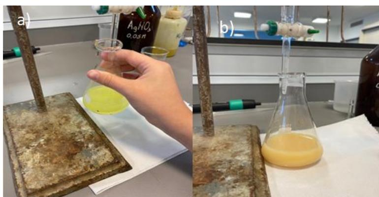
Figura 13. a) *Muestra para cuantificar cloruros sin titular*; b) *Muestra titulada*. *Elaboración propia (2022)*
