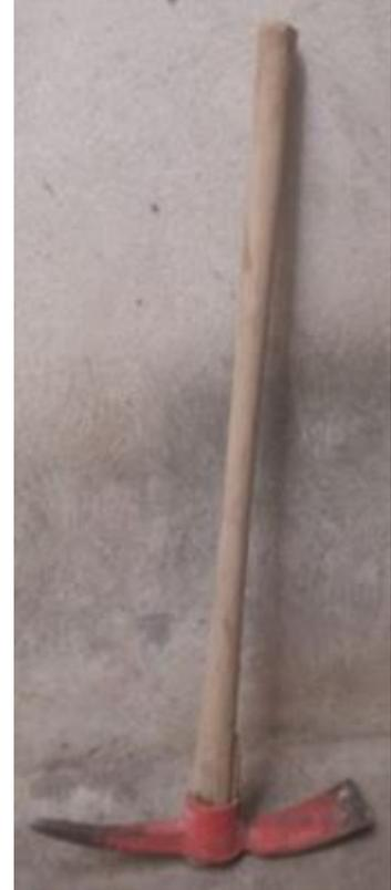
En las imágenes anteriores se observa palas de tipo ancha y punta y picos forjados con deficiencias en sus partes. El material de las de tipo punta es inadecuado por ser en su totalidad de hierro, material conductor de electricidad en el caso de estar en contacto con aquellas interferencias que no han sido cateadas. En las palas anchas y pico se observan deficiencias de material como astillas y grietas en la madera y en la longitud en sus mangos.
