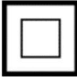
**Herramientas de Clase I.-** su grado de aislamiento corresponde a un aislamiento funcional, es decir, el necesario para asegurar el funcionamiento de la herramienta y la protección frente a contactos eléctricos directos, pudiendo llevar puesta a tierra.
