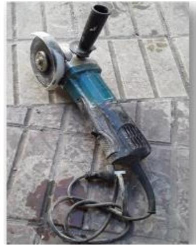
En las imágenes se observan las amoladoras que se utilizan para realizar las tareas. En la imagen 10 se encuentra flojo el protector de discos y requiere recambio de carbones. La imagen 11 no tiene el mango auxiliar de agarre y presenta empalmes encintados en su cable de alimentación. La amoladora de la imagen 12 se encuentra en correcto estado para su utilización.
