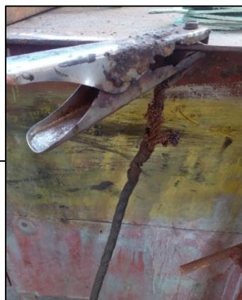
Imagen n° 4- Trabajo de soldadura Imagen n° 5- pinza en malas condiciones
