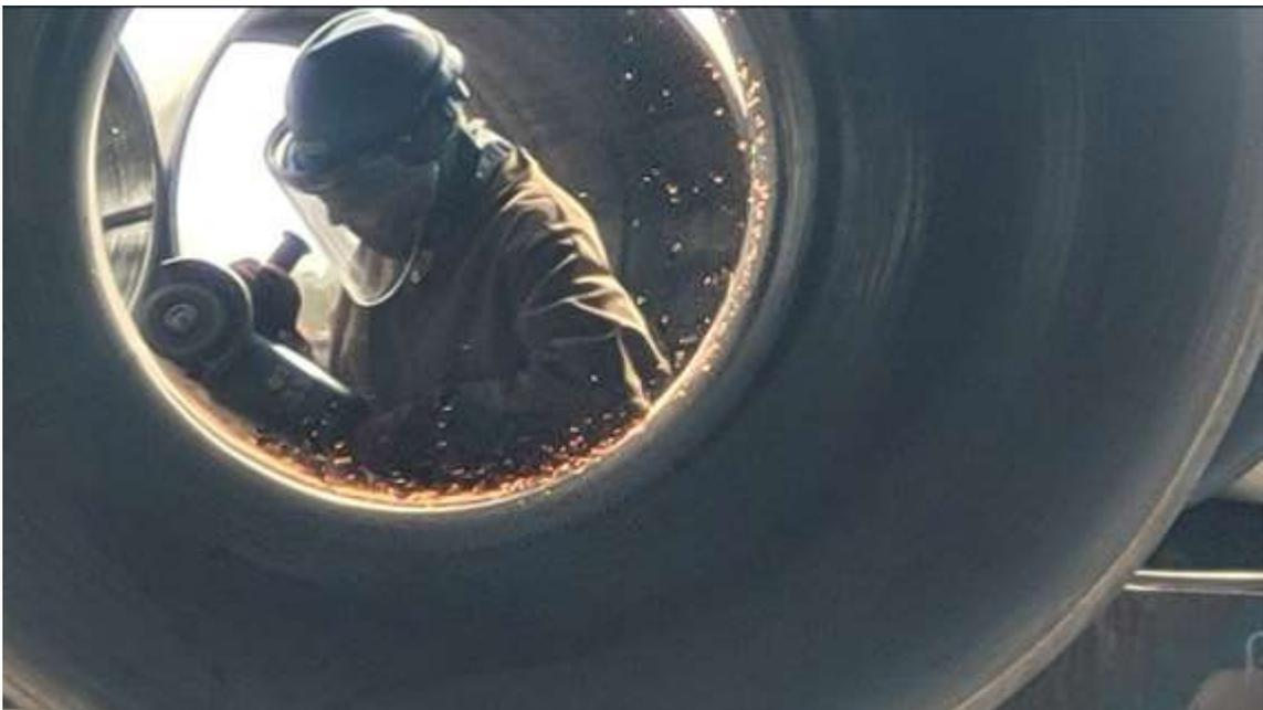
Son utilizadas en el proceso amolar la costura longitudinal interna de la tubería, en un largo de aproximadamente 30 cm en los externos a soldar. Además se utilizan en caso de tener que realizar alguna reparación de soldadura.
