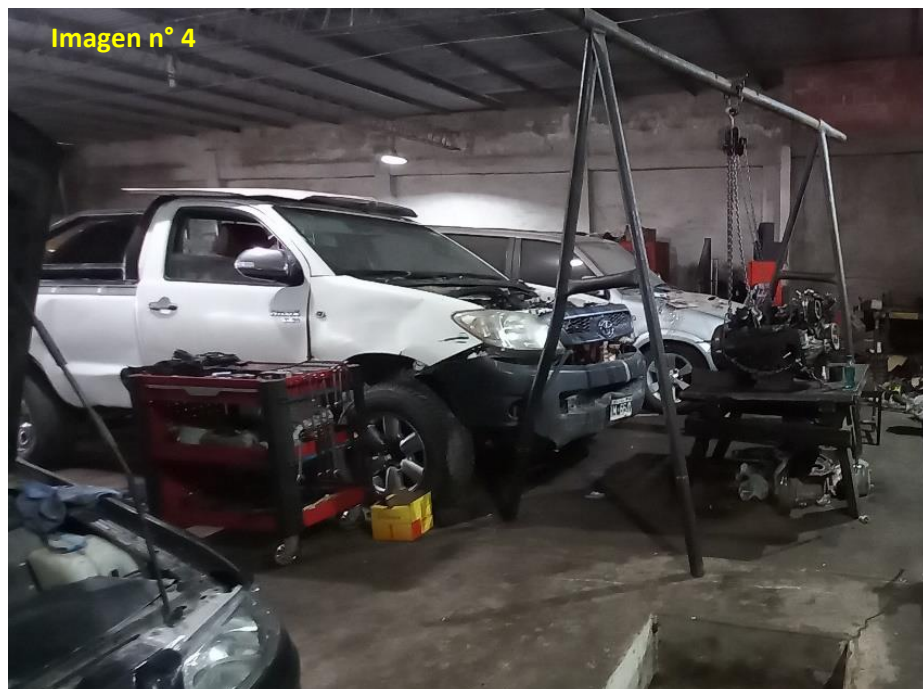
Imagen 4 zona de aparejo en cercanías de la fosa y sin delimitación ambos sectores
