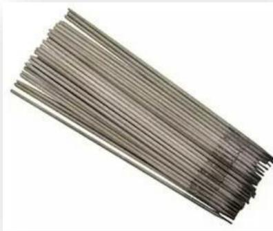
Funcionamiento: En su utilización el calor del arco eléctrico derrite el núcleo metálico de la varilla y asimismo al material base. Simultáneamente, el recubrimiento de la varilla de relleno produce una campana de gas y una capa de escoria, que actúan como una protección contra reacciones químicas de la superficie calentada de la pieza con el aire circundante. De esta manera se asegura la fuerza y durabilidad del metal soldado.
