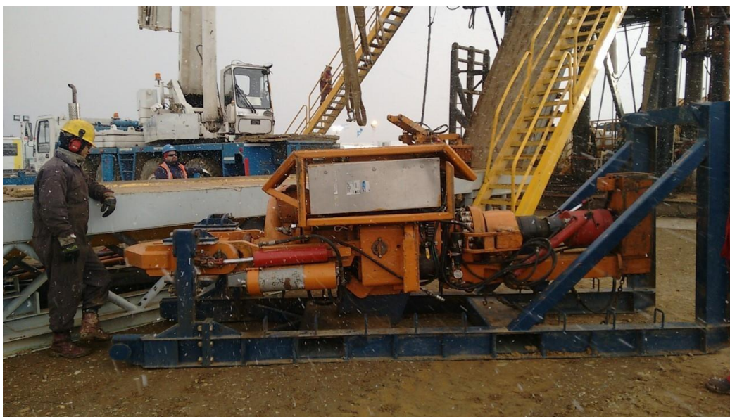
Izaje de TD con grúa
