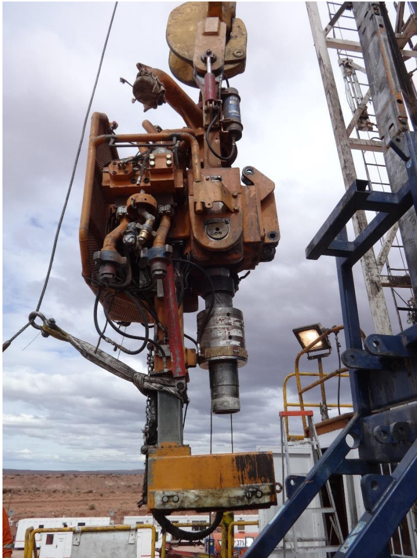
Winche utilizado como retenida en izaje de TD
