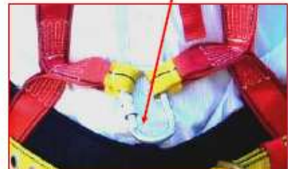
DETALLE DEL PUNTO DE ENGANCHE ANTICAIDA FRONTAL
