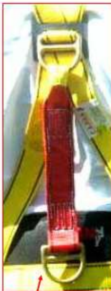
DETALLE DEL PUNTO DE ENGANCHE ANTICAIDA DORSAL
