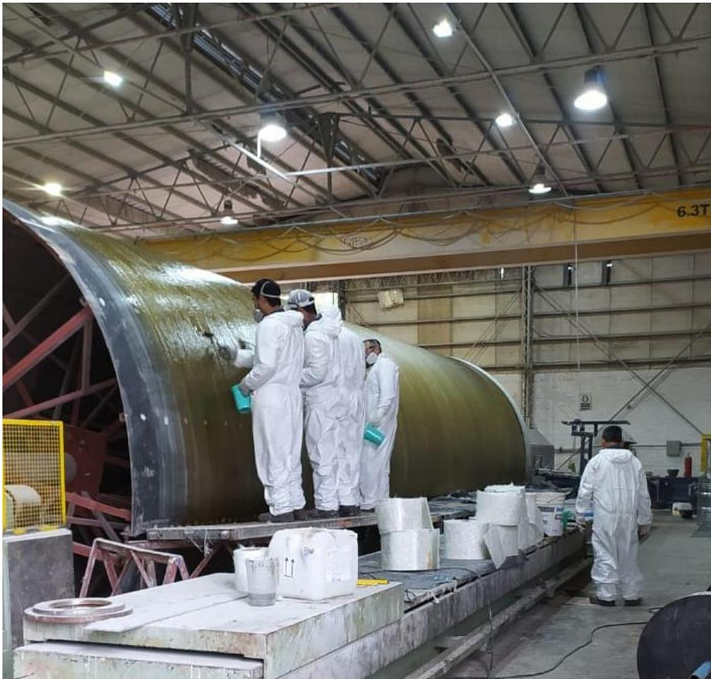
Como vemos en la imagen, el molde gira sobre un eje a una velocidad programada, al mismo tiempo se le van colocando las capas de fibra de vidrio según diseño de ingeniería de acuerdo al producto a almacenar.
