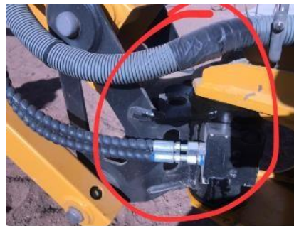
Canasta autoelevadora con pérdida de fluido hidráulico! MANTENIMIENTO URGENTE ya que se está usando para tareas críticas de montaje e izaje. Interno 194.
