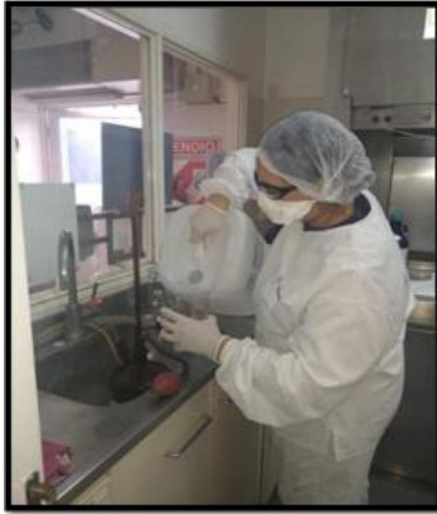
**ETAPA 3** – En un vaso de precipitado de vidrio de 100 ml. se coloca con pipeta volumétrica dedoble aforo de 10 ml de la solución con 50 ml de agua bidestilada y 10 ml de HCL 1:2 con indicador. Tarea realizada bajo campana.
