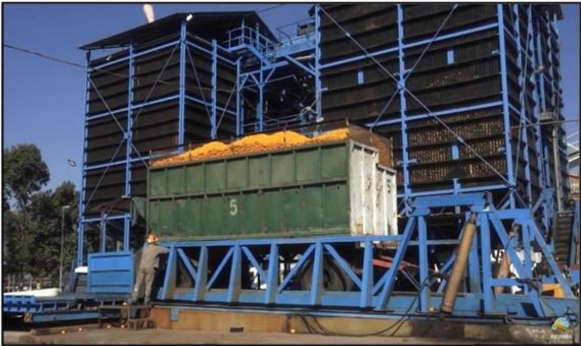
Transporte de la fruta hacia el proceso de extracción de aceites mediante cinta transportadora, hacia mesa de primera selección, luego al elevador de canjilones y a las cintillas por las que se cargaran los diferentes silos. Luego según demanda por características de la fruta, se carga la cinta bajo silos y de ahí pasa al piletón (Hidro inmersor), don se realiza un primer enjuague de la fruta.
