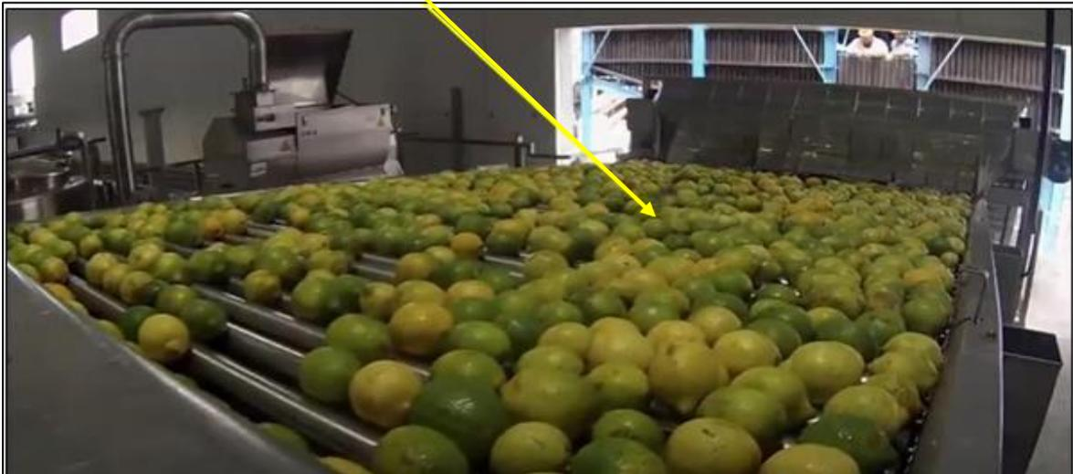
Lavado de la fruta seleccionada mediante lavadora: en esta máquina, se rocía la fruta con agua por medio de aspersores, y se quitan las impurezas con los rolos compuestos por cepillos. Al finalizar el lavado, ingresan a **las cintillas 1 y 2**.
