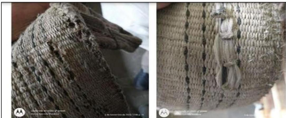
Luego de realizar la inspección se da de baja 2 eslingas:
