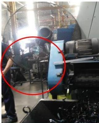
Ventilador de pie, obstruyendo el camino y con cables sobre el piso
