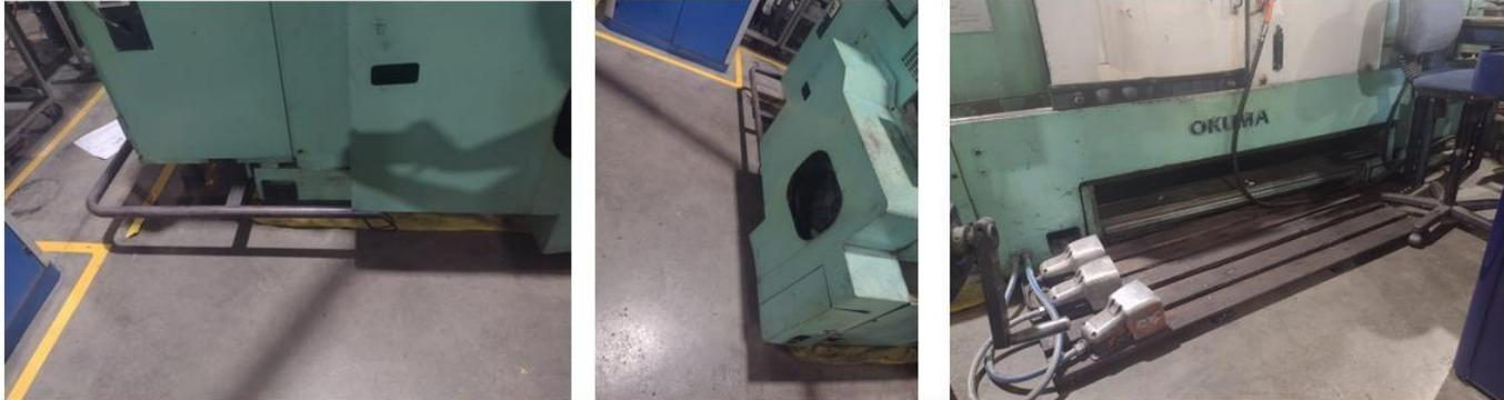
Luego del manteniendo de la maquina LB25 por perdida de gran cantidad de soluble, se realizan pruebas, las cuales muestran que el arreglo fue correcto. Se procede al retiro de los trapos que se utilizaban para contener el derrame, y se realiza una eficaz limpieza en el sector. El miércoles 2/3 se realizara demarcación en el sector de la maquina con líneas amarillas.
