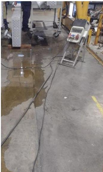
En la línea de montaje, se encuentra un tablero secundario que es utilizado para alimentar las herramientas eléctricas que se utilizan en el sector. Como muestra la imagen (Ver foto 1.8), el tablero no se encuentra: señalizado, ubicado estratégicamente para no obstruir el paso, las prolongaciones se encuentran a nivel del suelo; y al producirse un derrame de del líquido de una pieza (que proviene de la prueba hidráulica), se encuentra sobre el agua.
