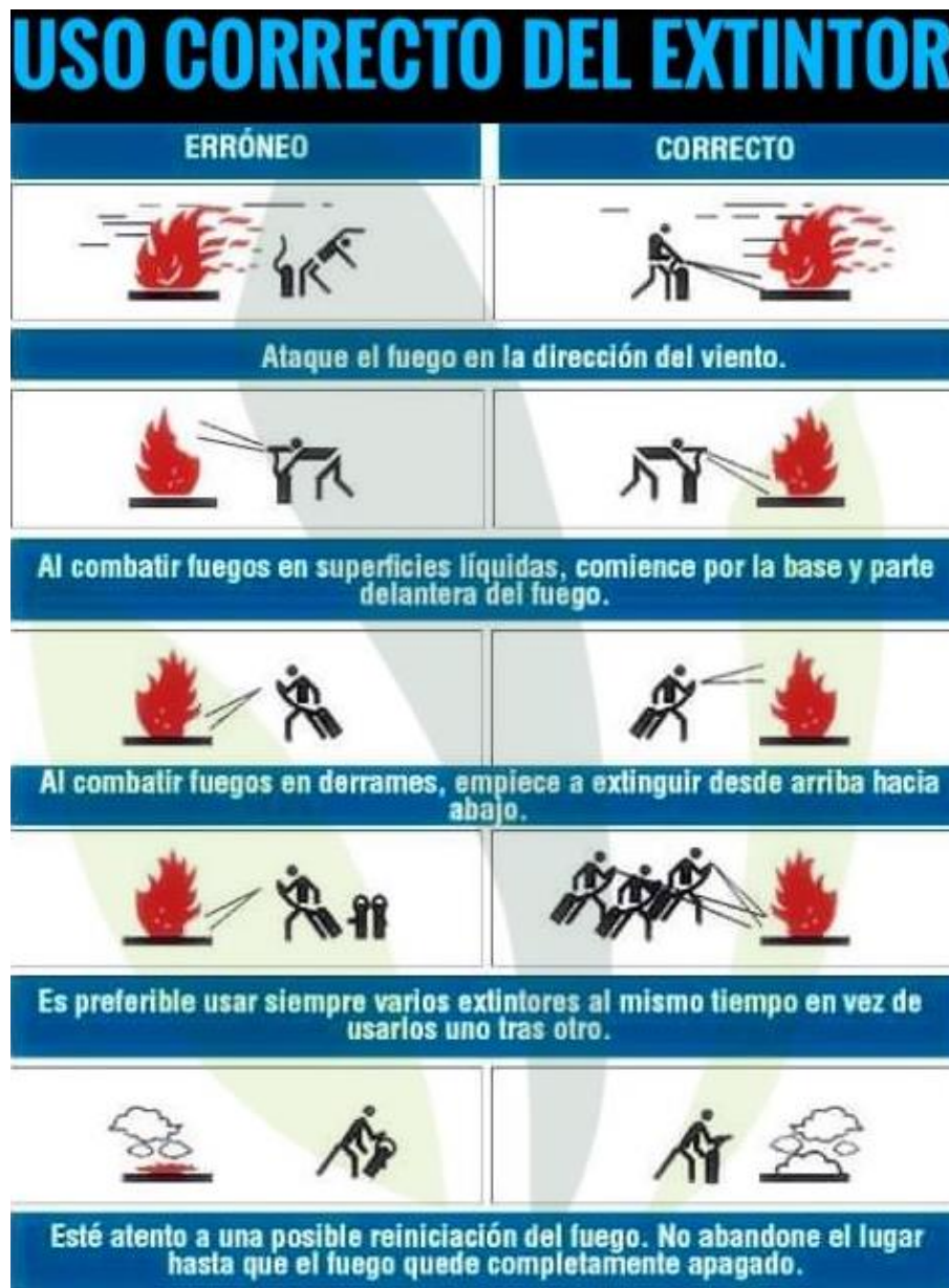
FOTO N°41: Uso erróneo y correcto del extintor. Google Imágenes.
