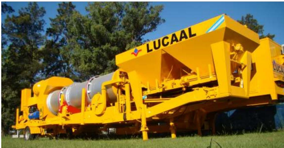
FOTO 3: Planta Asfáltica LUCAAL EM 80.
