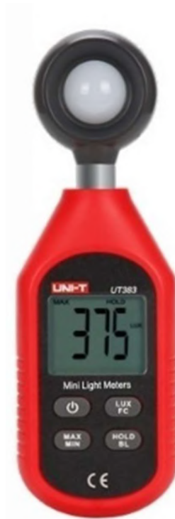
Ilustración 2 Luxómetro UNIT-T UT383 Mini Digital.
