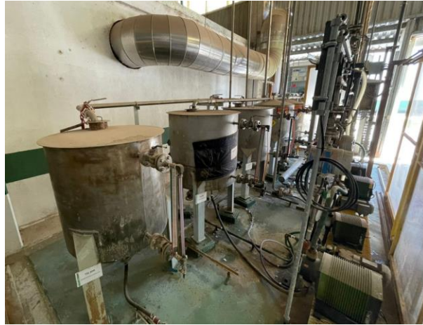
Foto 9. Dosificadores de gluco-milasa, alfa-milasa, hidróxido de sodio y ácido sulfúrico (vista sin protección).
