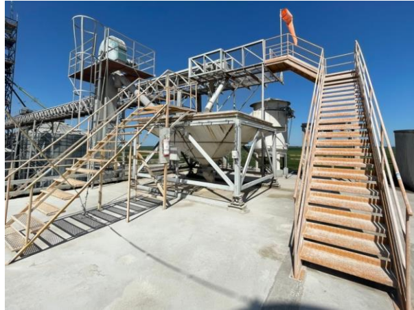
Foto 2. Cinta transportadora y tolva pesadora.
