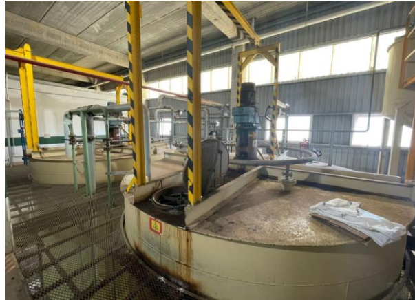
Foto 6. Licuefactores vista superior.
