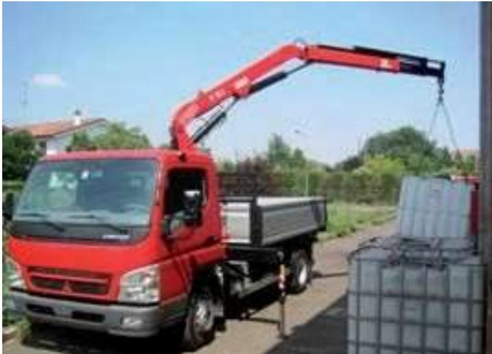
Grúa autocargante con un chasis de dos ejes.
