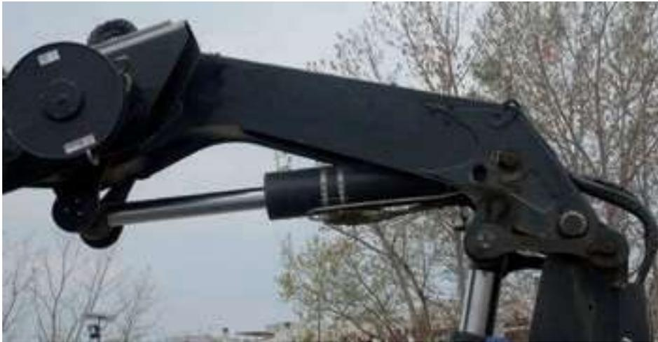
Permite la articulación y el plegado del conjunto sobre la columna, cuya estructura es muy robusta por las presiones que debe soportar el brazo articulado.
