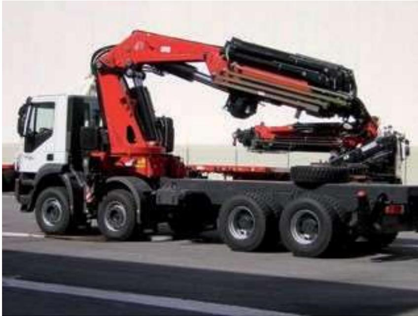
Grúa autocargante con un chasis de cuatro ejes
