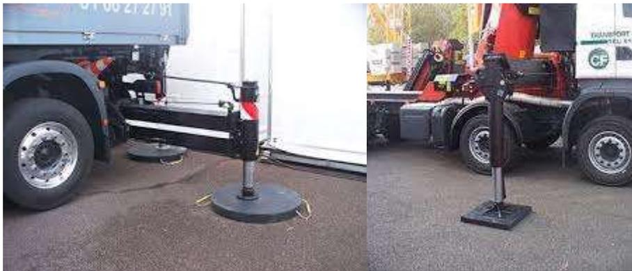
Gatos hidráulicos con placa estabilizadora
