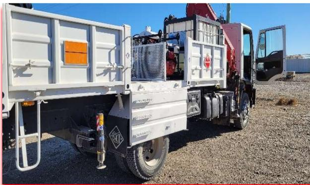
Camión equipado con equipos de lavado
