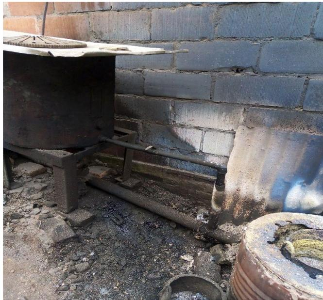
Figura 1.7 tobera y caño de aire del horno
