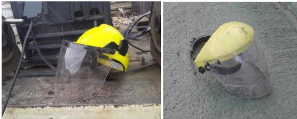
*Acción preventiva / correctiva 1: Actualmente se proveen dos tipos de protección facial, que se utiliza conjuntamente con protección ocular básica. Se propone la protección facial sujetos a casco que garantiza la protección del cráneo en todo momento.*
