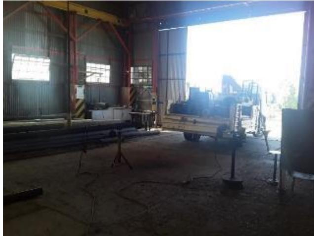
*La empresa no posee un sistema de extracción de aire localizado que asegure la renovación del aire, utiliza la natural que puede obtener con portones abiertos.*
