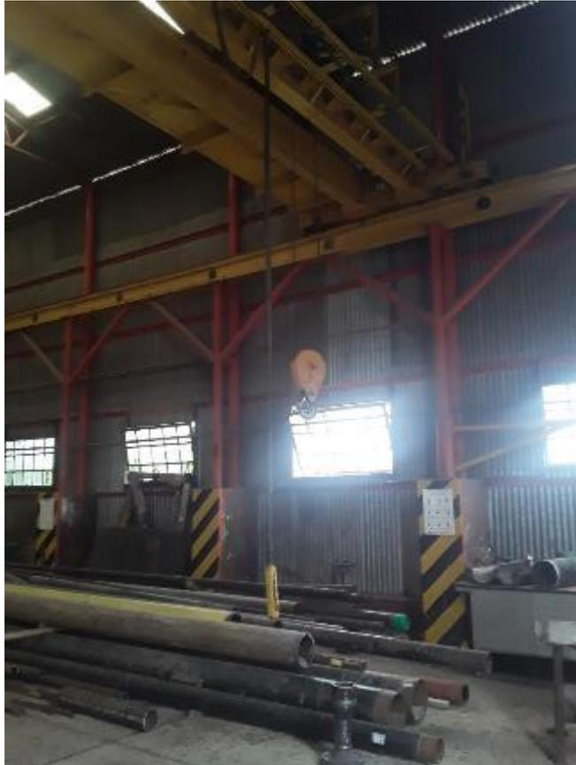
*En la nave de soldadura se halla instalado un puente grúa y monorriel con pluma para reducir el manejo manual de cargas y se aumente la seguridad durante la operación.*
