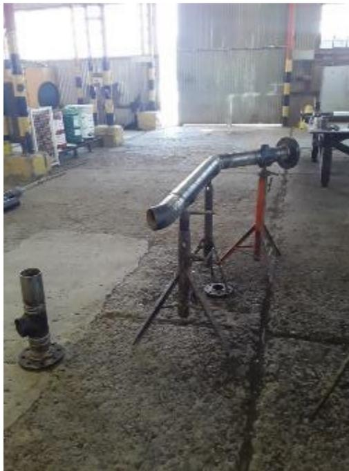
*Trípodes regulables para asegurar la fijación de los prefabricados.*
