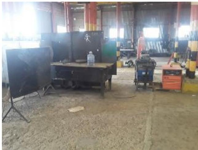
*La superficie porosa del suelo alberga polvo metálico resultante del corte y desbaste y los portones abiertos para ventilación permiten el ingreso de viento con tierra constituyendo material particulado en el aire.*
