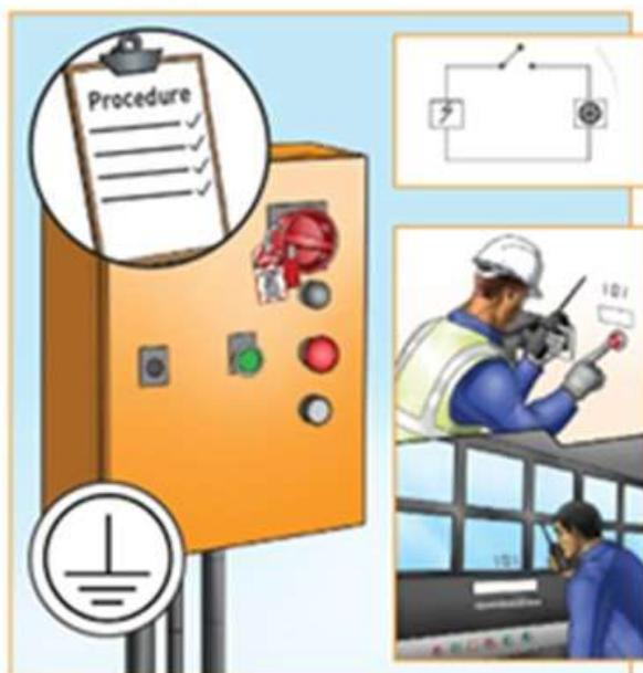
Antes de comenzar cualquier trabajo eléctrico, deberá seguirse un procedimiento aprobado de aislamiento de la energía eléctrica (abrir, probar si está muerto, bloquear y etiquetar).
