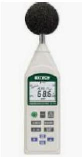
El método elegido para realizar la medición de cada puesto de trabajo es partir de medición de niveles sonoros continuos equivalentes (LAeq,T). Para ello se utilizó un medidor de nivel sonoro integrador también llamado sonómetro integrador. El sonómetro dispone de filtro de ponderación A en frecuencia y respuesta temporal “lenta” o “slow”.
