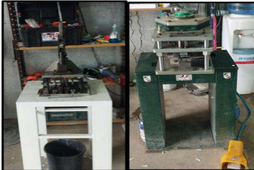
Es una máquina que se utiliza para perforar, realizar los agujeros y ranuras en ventanas y puertas de aluminio. Disponen de tres tipos de punzonadora, una manual que se utiliza con la línea Herrero, y dos neumáticas que se utilizan en línea Módena.
