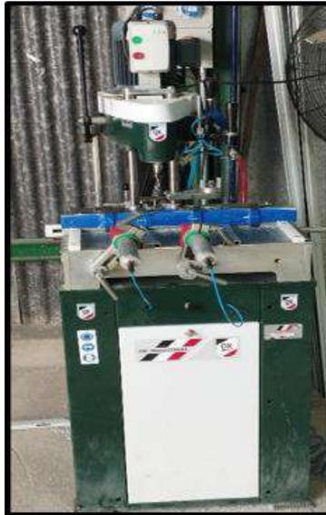
Esta máquina se utiliza para el mecanizado de algunos perfiles en los cuales la punzonadora no puede realizarlo, para ello se utiliza la copiadora que complementa los mecanizados de perfiles, realizando trabajos como bocallaves, agujeros para cerraduras, agujeros para alojamientos de ruedas de mosquiteros, tiradores de plásticos entre otros.
