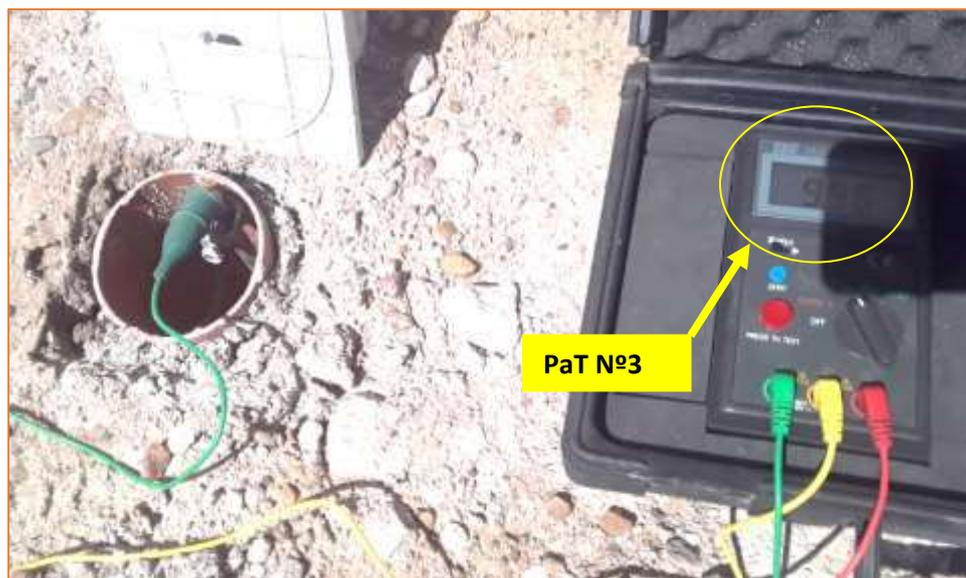
Imagen N° 5 – Valor medido en  $\Omega$  de PaT N° 3.
