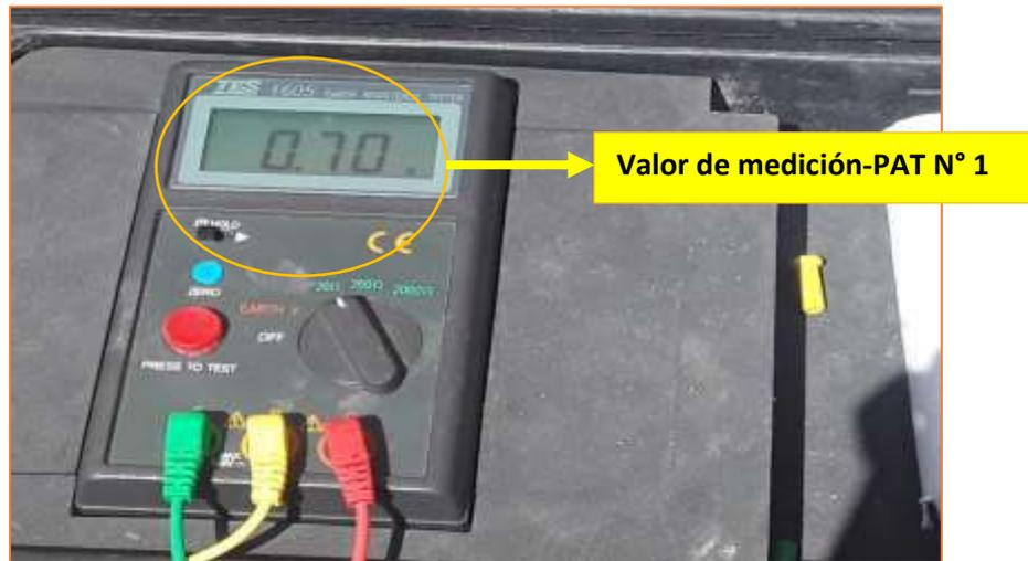
Imagen N° 3 – Valor medido en  $\Omega$  de PaT N°1.
