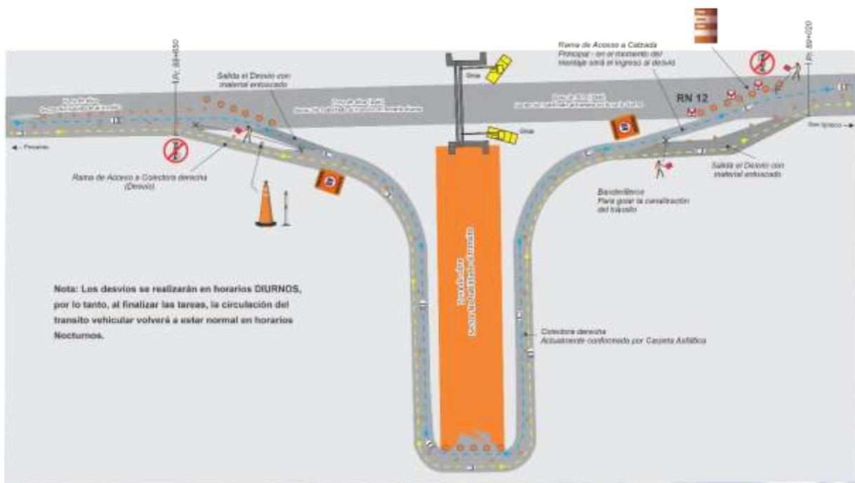
Las áreas de trabajos de las grúas deben de ser amplias por el radio de acción de cada una, por seguridad se debe respetar dichas medidas. Para el tránsito ajeno a la obra debe ser canalizado por medio de banderilleros y en horarios diurnos así la visibilidad es mejor, sin embargo, se debe suspender el izaje crítico en días donde el clima no es favorable o está bajo tormentas y vientos fuertes.
