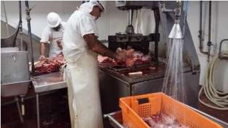
Luego de separar la quijada, se realiza la apertura de cabeza con hachadora hidráulica. Producto de esta tarea, se retiran los sesos y se colocan en canastos para posterior lavado con lluvia de agua potable. Se colocan en canastos con doble fondo cribado (máximo 3 filas) para su escurrido y posterior enfriamiento a máx. 3°C en cámara de maduración.
