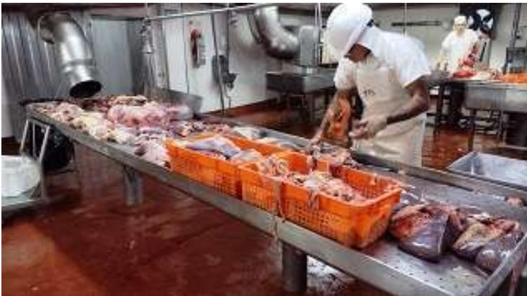
Los hígados son trabajados bajo lluvia de agua potable para realizar el dressing, y luego son colocados en canastos plásticos con doble fondo cribado, y son transportados a la cámara de maduración, para su enfriamiento.
