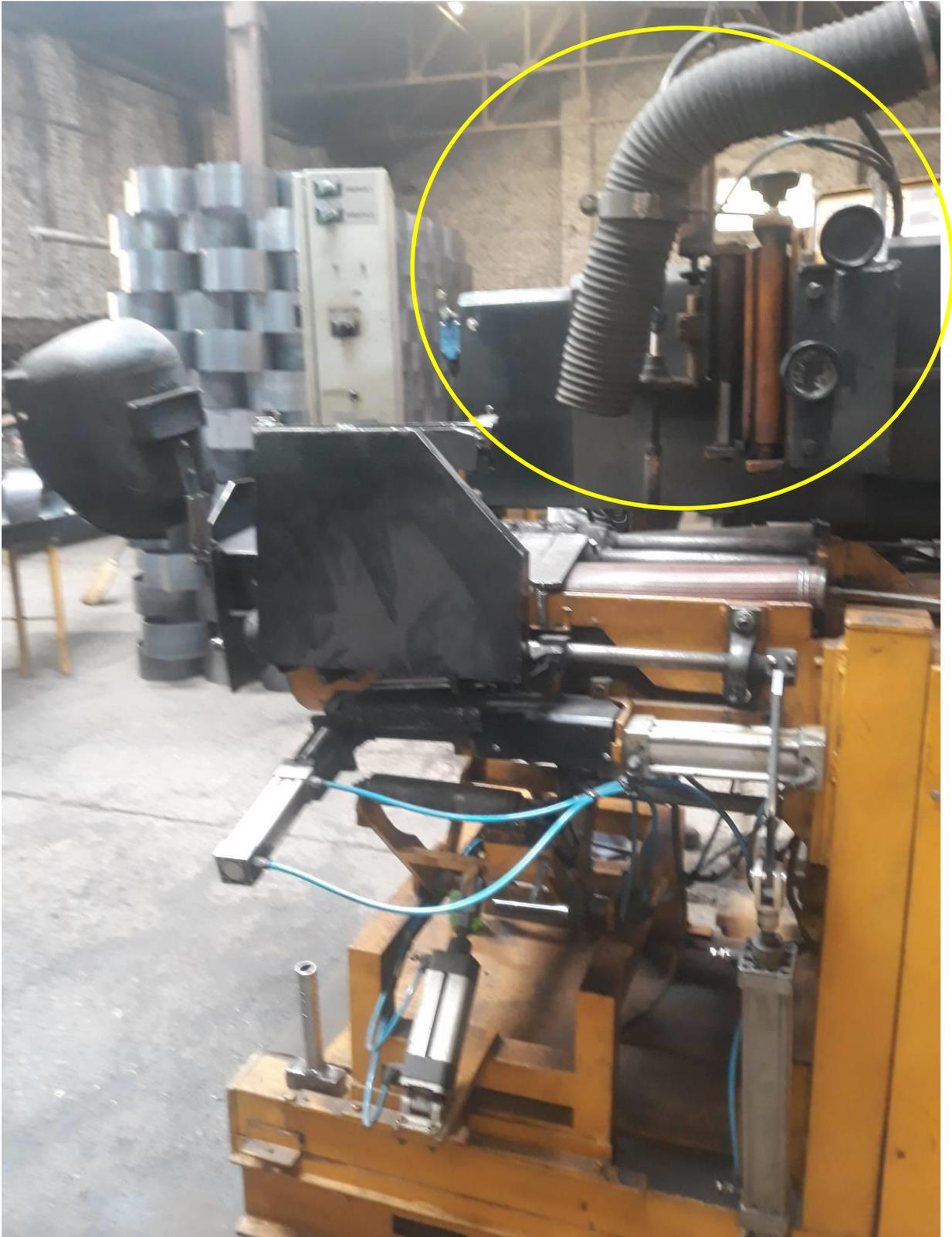
Imag. Extractor de humo de soldadura
