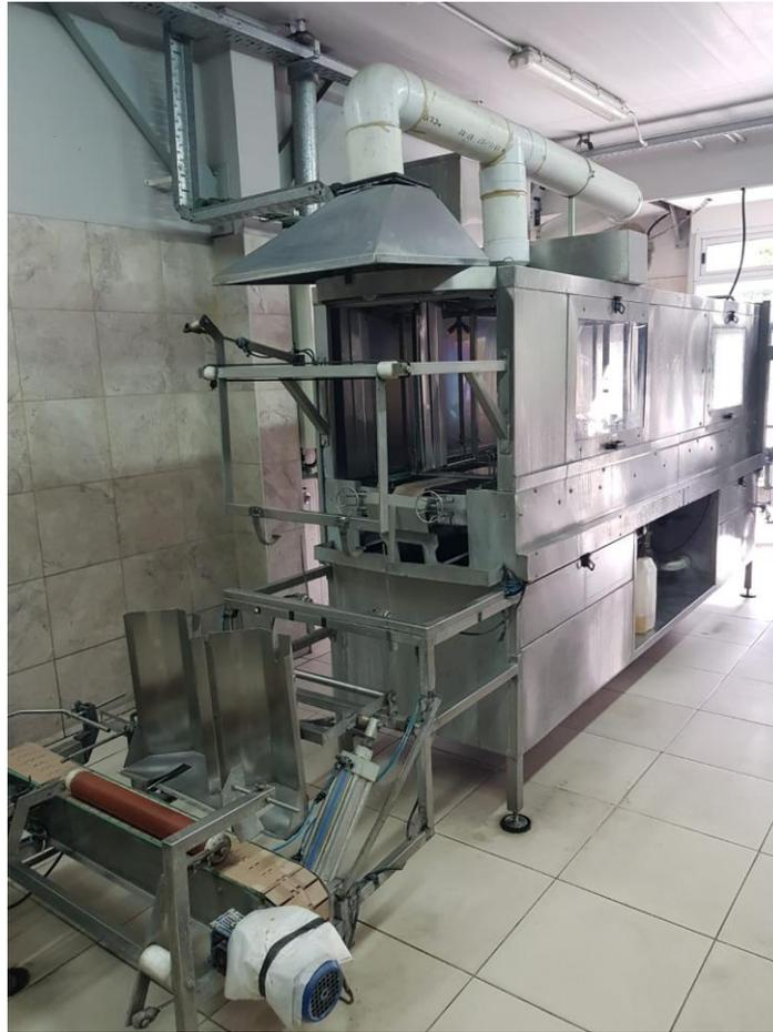
En la segunda lavadora, los envases ingresan de a pares. Esta contiene 18 canastos metálicos que sujetan los picos de los bidones. Funciona con un moto reductor, que impulsa una cinta transportadora, la cual traslada los canastos. Además, contiene dos bombas lavadoras, dos depósitos de 200 litros de agua, una caldera para calentar el agua del primer saneado y dos termostatos de corte y regulación de temperatura.
