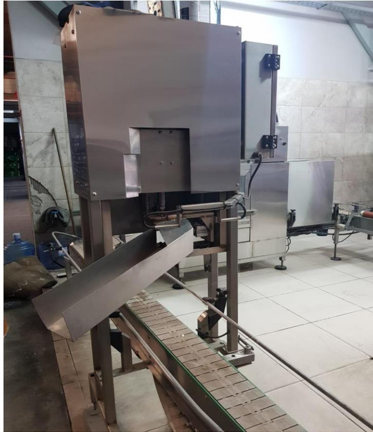
En esta primera instancia, el operario ingresa manualmente a la cinta transportadora el bidón vacío, extraído de un cajón que fue transportado por el auto elevador. Mediante un sensor que toma el paso del envase, el PLC, envía la señal a un cilindro que se encarga de bajar un aro de teflón con una abrazadera de aluminio, los cuales separan la tapa plástica del bidón, y la envían mediante un canal a un recipiente.
