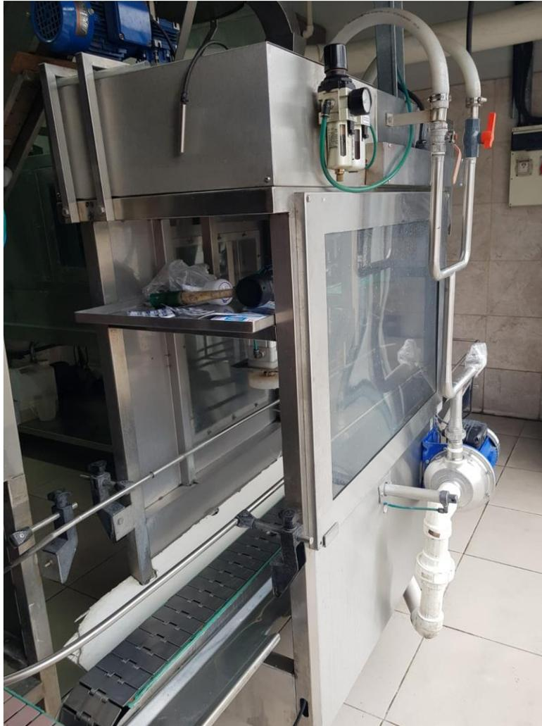
Luego de ser saneados por dentro y fuera, los envases a través de una cinta transportadora, son enviados a los picos llenadores. Al momento de pasar de a dos envases por un sensor, se posicionan en los picos, y mediante electroválvulas, una bomba envía el agua ya tratada y recientemente ozonizada, a los bidones.
