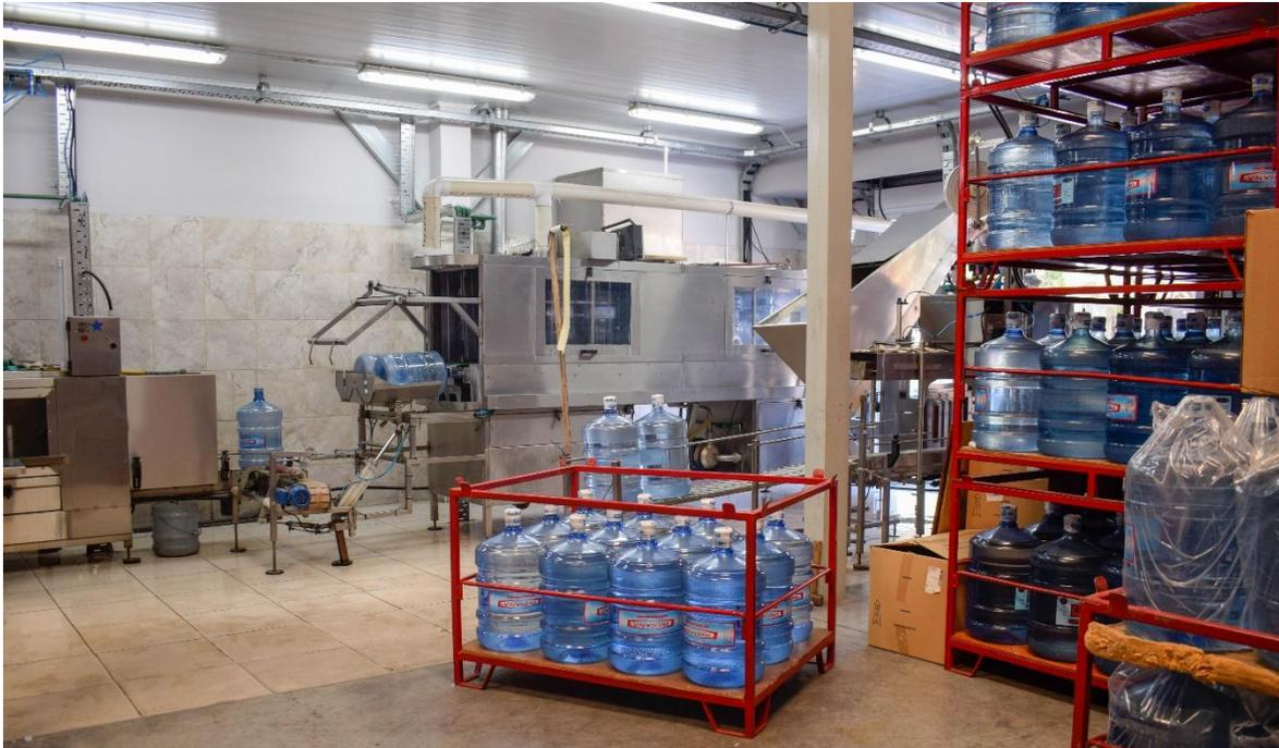
Todos se almacenan en cajones de 12 unidades, fabricados especialmente para poder manipularlos con un auto elevador. En dicha línea de producción, uno de los operarios es el encargado de conducir el auto elevador, manejar el almacenamiento y de abastecer de envases vacíos, y de extraer los cajones una vez que son completados con bidones llenos. Los otros dos operarios son los encargados de supervisar y vigilar cada etapa del envasado y de insertar los envases a la línea.
