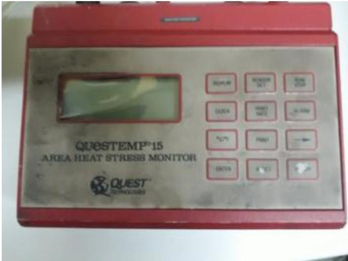
*Dispositivo utilizado para la medición de carga térmica*
