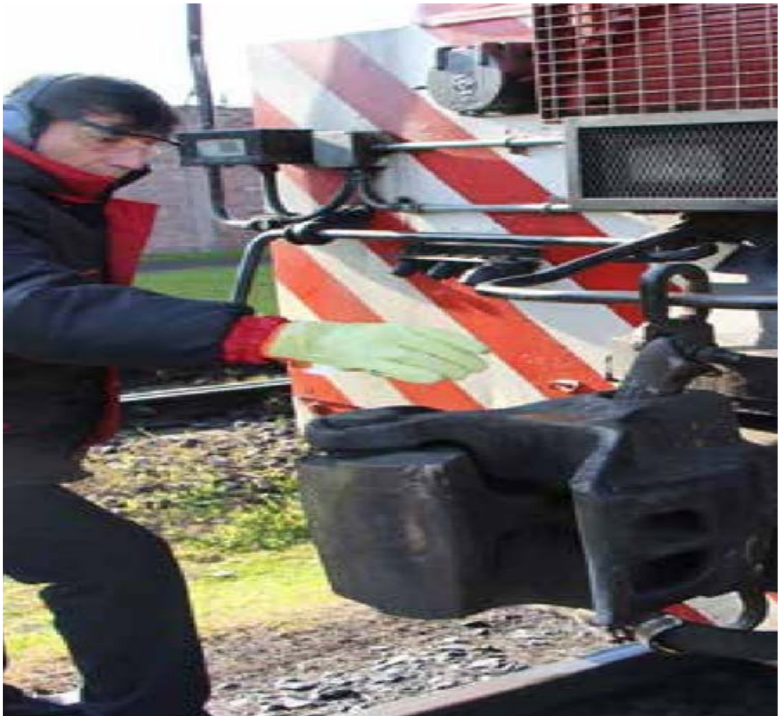
Anexo fotográfico 1 Operación Manual de Acople
