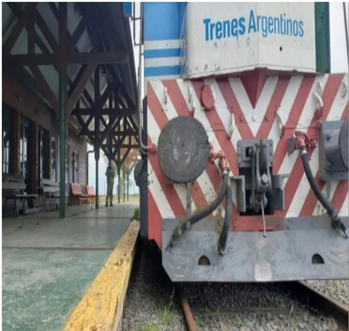
Anexo fotográfico 5 Locomotora diésel modelo 1965, posee enganche tipo muela
