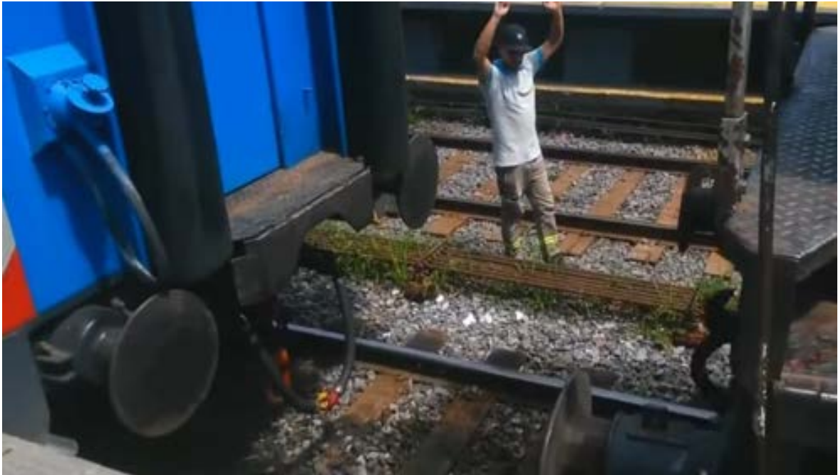
Anexo fotográfico 10 Operario en Señalización de maniobra
