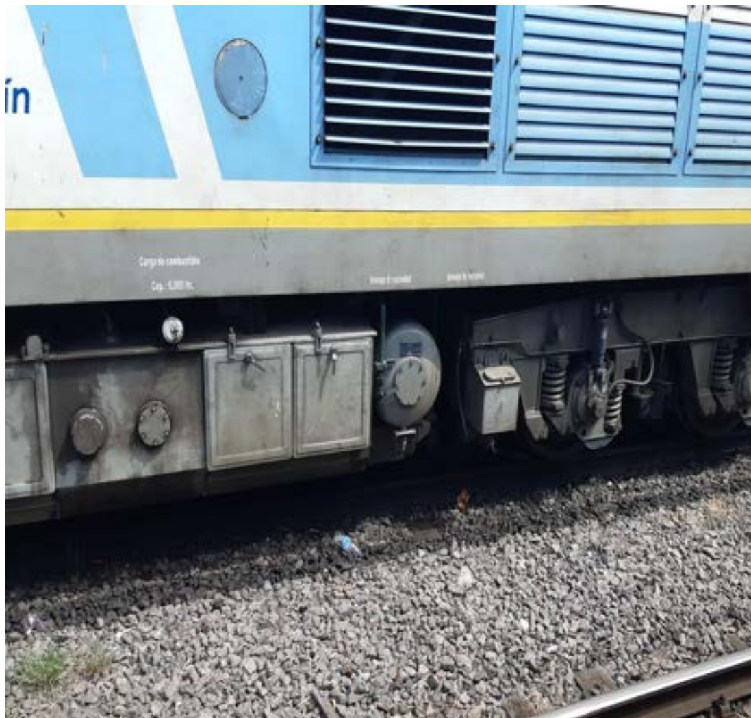
Anexo fotográfico 8 desagote de drenaje de suciedad, filtro de combustible
