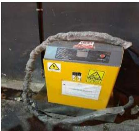
Cargador de baterías del autoelevador
