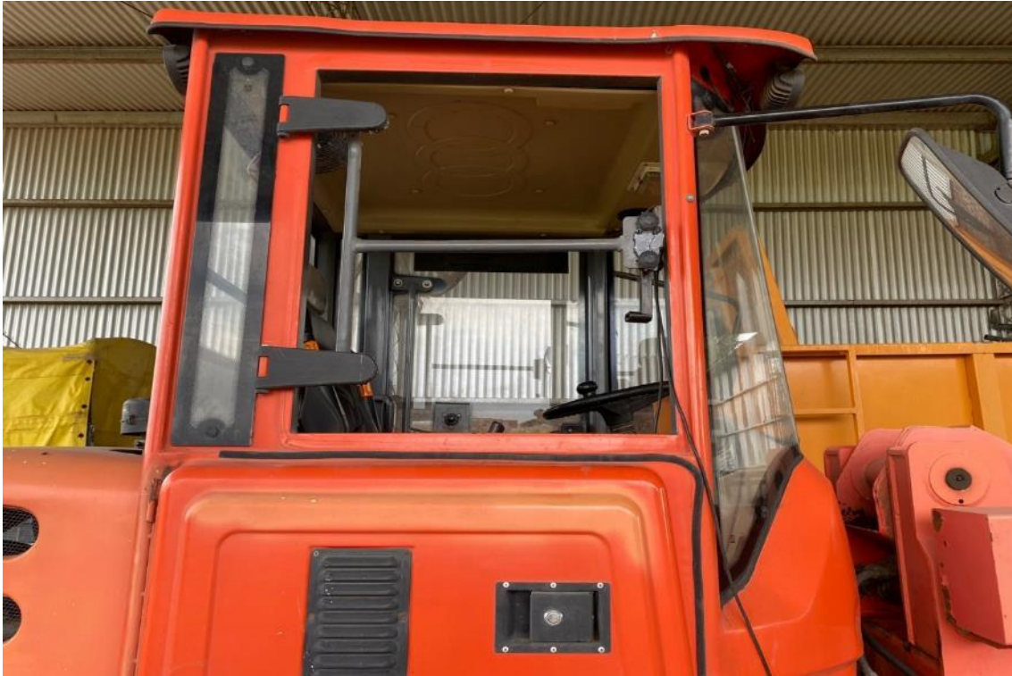
Imagen 2.8: Se observa faltante de ventanilla lateral derecha. Existe riesgo de golpes contra objetos ya que no posee ninguna protección que impida el ingreso a la cabina del tractor.
