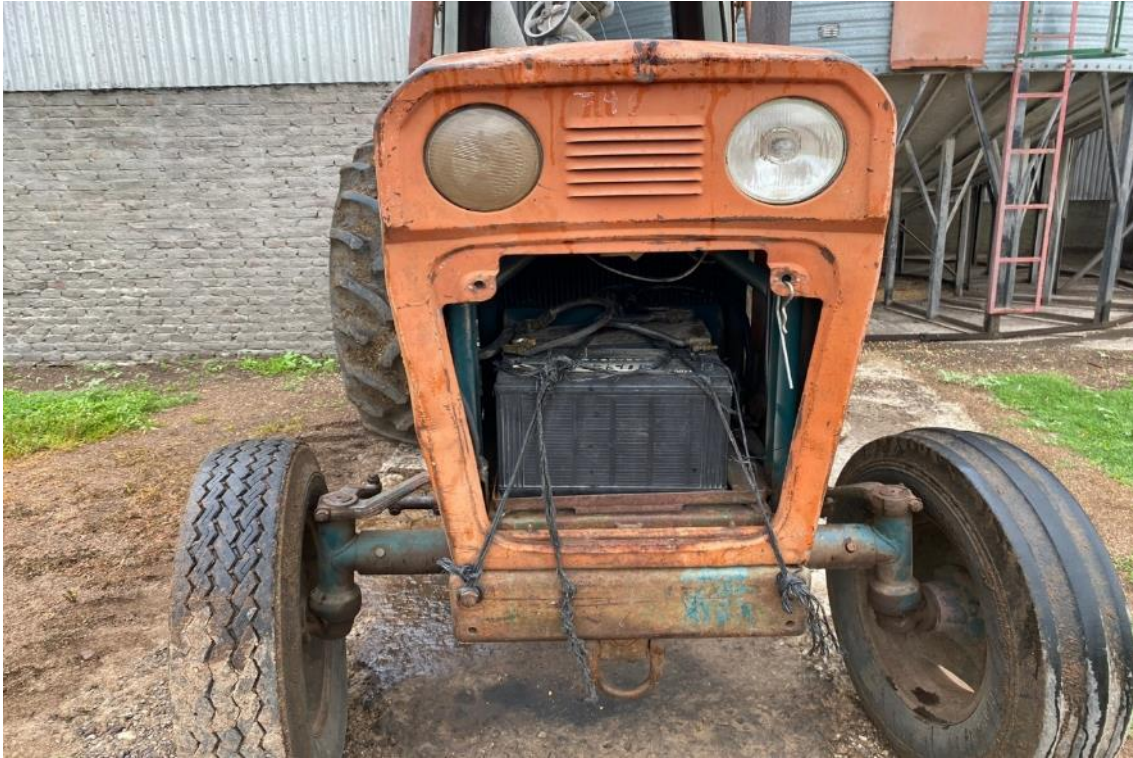
Imagen 2.5: Falta protección frontal. Batería sujeta con sogas. Cubiertas con distintos dibujos. Existe riesgo de atrapamiento en caso de vuelco como consecuencia de utilizar cubiertas distintas.
