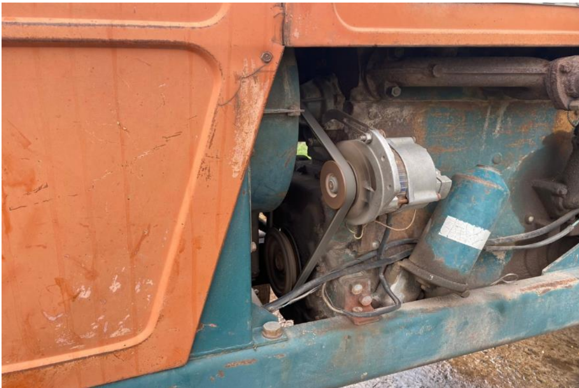
Imagen 2.4: Se observa falta de protecciones en laterales. Existe riesgo de que el trabajador tenga contacto con partes móviles del tractor.
