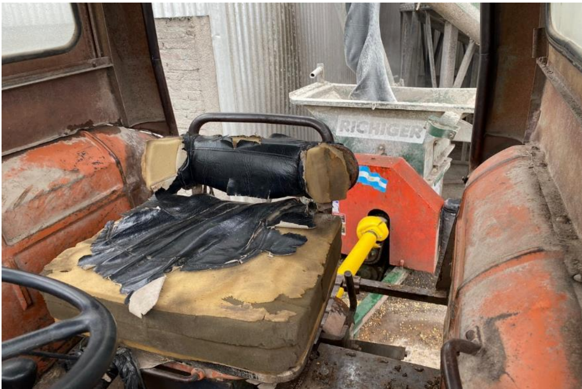
Imagen 2.6: Se observa asiento en estado deteriorado, sin respaldo y sin sistema para la absorción de las vibraciones. Existe riesgo de ergonómico.
