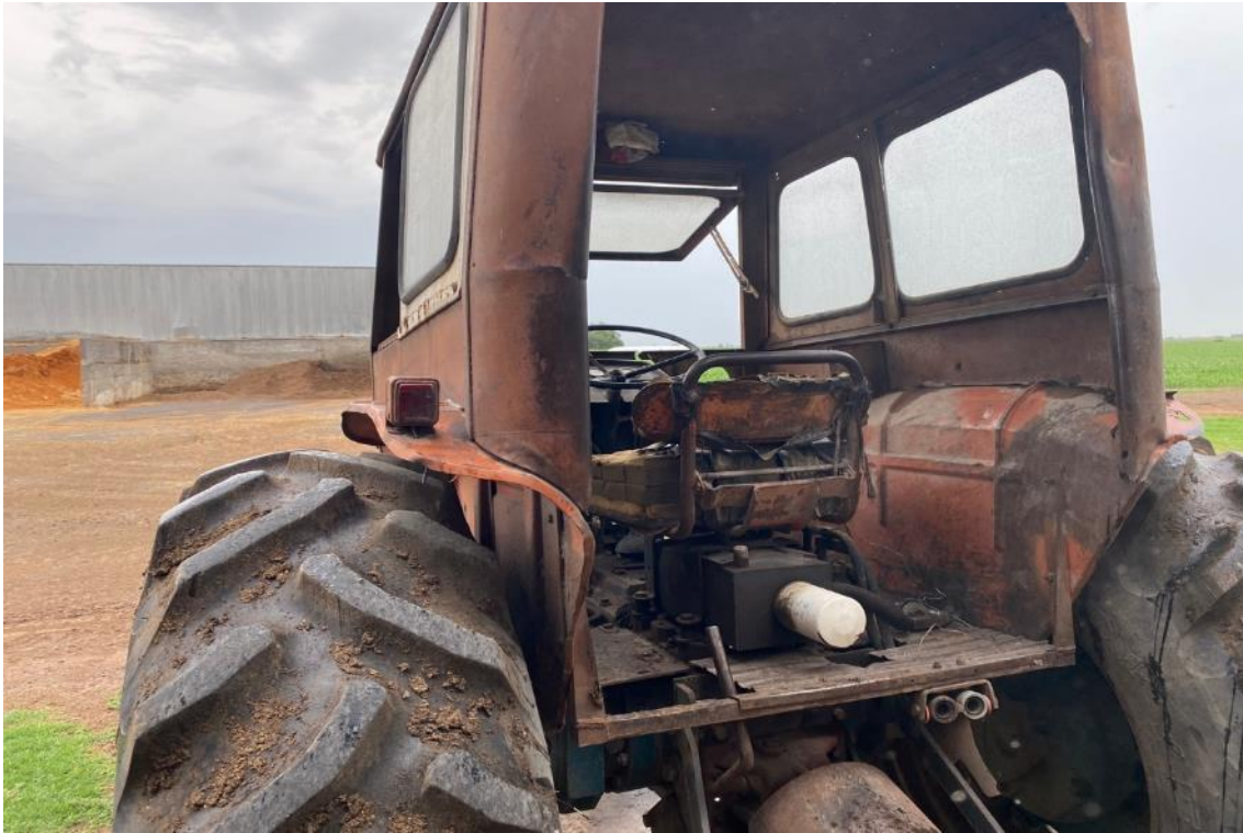
Imagen 2.3: Se observa faltante de extintor ABC. En caso de incendio se dificultan las tareas de extinción.
