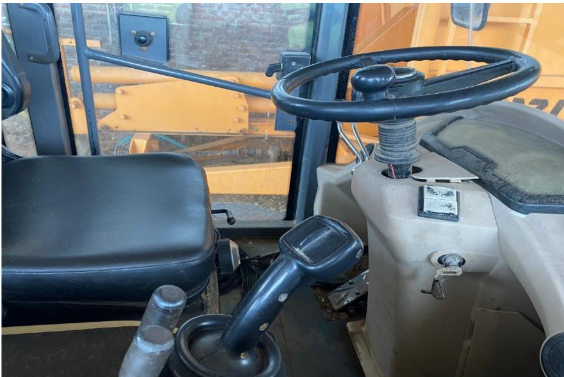
Imagen 2.9: Se observa faltante de extintor ABC. En caso de incendio se dificultan las tareas de extinción.
