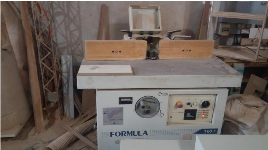
La máquina tupí se utiliza para la modificación de perfiles de piezas de madera, por creación de ranuras, galces, molduras, etc., mediante la acción de un útil recto o circular que gira sobre un eje normalmente vertical, aunque en determinados casos puede ser horizontal (útil montado sobre el eje de una universal).
