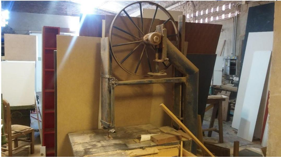
Fabricada en acero, su objetivo es aprovechar al máximo la madera, descartando lo mínimo posible de materia prima. La hoja o cinta de corte en este caso es de dientes rectificadas y separadas. Además, al ser su velocidad de corte media-alta, la fricción obtenida al interactuar la sierra con la madera es considerablemente baja. También sirve para cortar aglomerados y superficies de símil madera.
