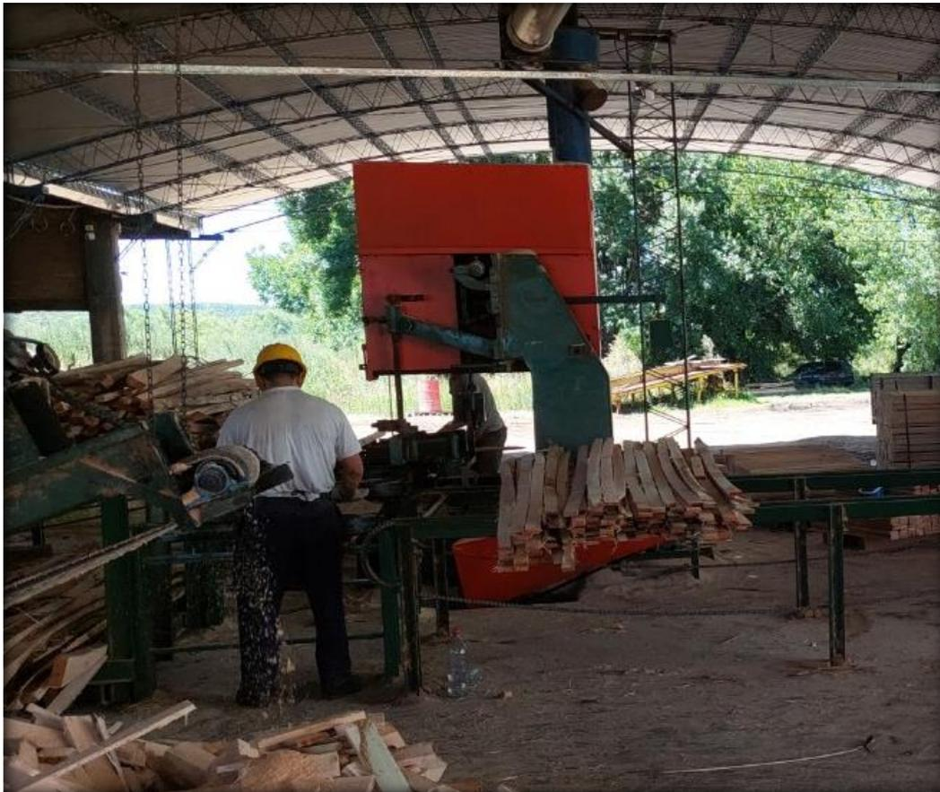
Esta máquina se utiliza para recuperar tablas (de cortes más grandes) defectuosas que provienen de la máquina de sierra tablera o la sierra múltiple, para poder aprovechar sacar cortes más pequeños útiles para la comercialización.
