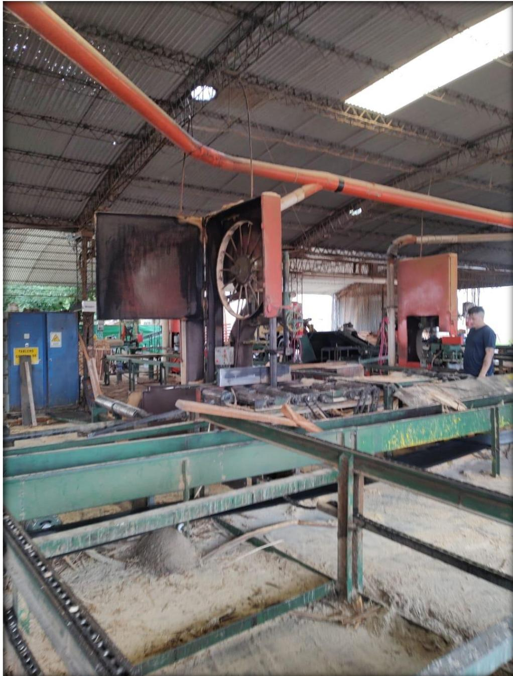
El trabajo se realiza sobre la máquina tablera, la madera es depositada en una mesa adyacente desde la sierra carro, que sirve para el depósito de la madera a trabajar. Sobre este puesto se requiere la presencia de cuatro operarios. Un operador principal al frente de la máquina, otro por detrás de éste, quien acerca la madera desde la mesa adyacente. Del otro lado de la máquina se sitúan un operario que va sacando el descortezado y lo deposita en un montículo, en tanto que el otro va
