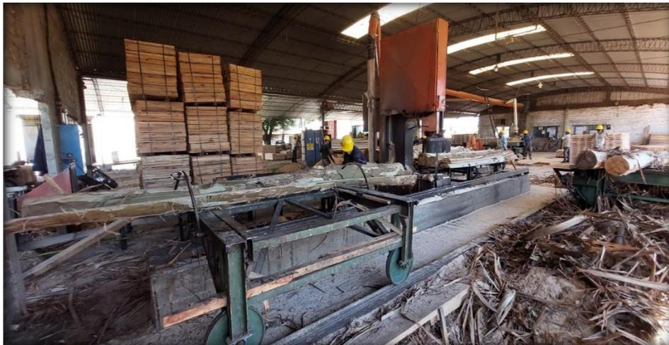
El trabajo se realiza sobre una sierra, la cual cuenta con un carro que se desplaza en sentido paralelo a la misma. El trabajo consiste en descortezar dos de sus lados, de manera que se formen  $90^\circ$  en estas caras. La madera es depositada por el tractor cargador en una mesa de trabajo, desde la cual se va seleccionando para su aserrado.
