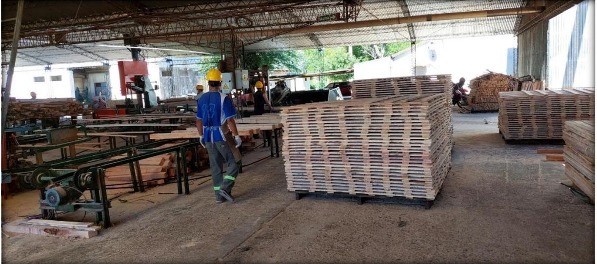
En este proceso el trabajador se encarga de realizar el estibado de la madera (tablas) como producto terminado al finalizar la línea de producción. Levanta los mazos de las tablas desde la mesa de salida de la sierra despuntadora y los transporta manualmente hasta estibarlos sobre pallets o tacos donde comienza a formar la estiba que conforma el paquete de tablas.
