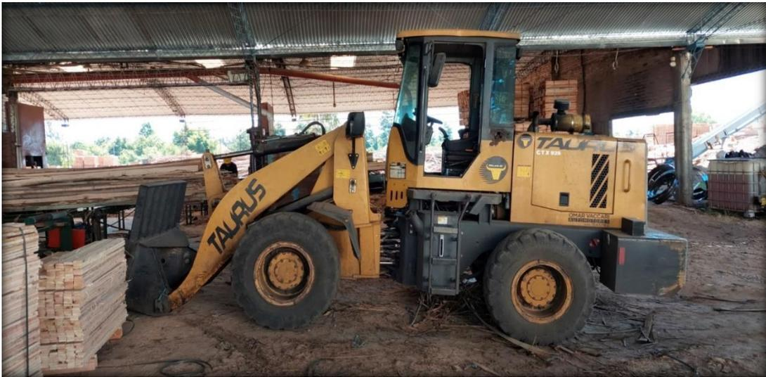
El trabajo se realiza operando maquinaria pesada, del tipo tracto-cargador. Las tareas que realizan consisten en cargar rollizos acopiados en la parte posterior del predio y trasladarlo dentro de la planta utilizando la playa de maniobra de la misma. Existe necesidad de ingresar a la superficie cubierta de la planta. De acuerdo a las actividades, colabora en otros puestos. También se realiza la limpieza del sector.
