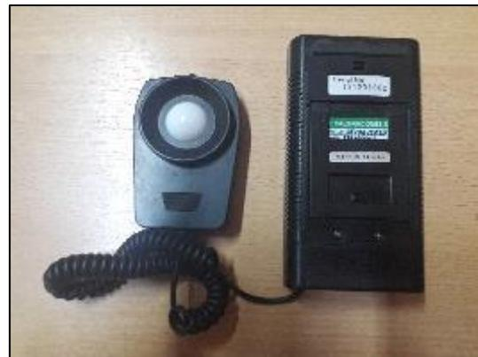
*Instrumento de medición: Luxómetro digital portátil, marca TES modelo 1330 A.
