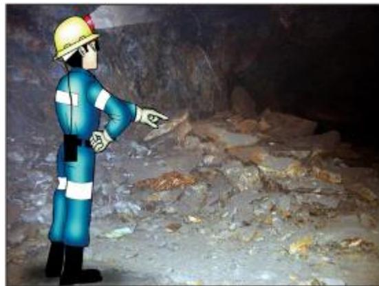
*Saneamiento manual: Condiciones inusuales: superficies mojadas o nuevas filtraciones de agua y huellas frescas de rocas caídas. Fuente: Manual de Geomecánica aplicada a la prevención de accidentes por caída de rocas.*
