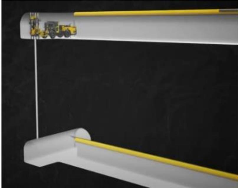
2. Se perforan las filas de producción, esto puede ser antes o después de la apertura de la rainura. Dependiendo de las características de la veta, pueden ser verticales paralelos o en abanico
