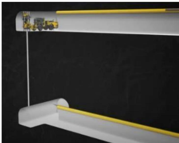
Se perforan las filas de producción, esto puede ser antes o después de la apertura de la rainura. Dependiendo de las características de la veta, pueden ser verticales paralelos o en abanico
