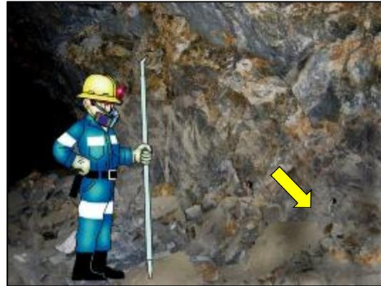
*Saneamiento manual: Condiciones inusuales: presencia de tacos y presencia de tiros cortados. Fuente: Manual de Geomecánica aplicada a la prevención de accidentes por caída de rocas.*
