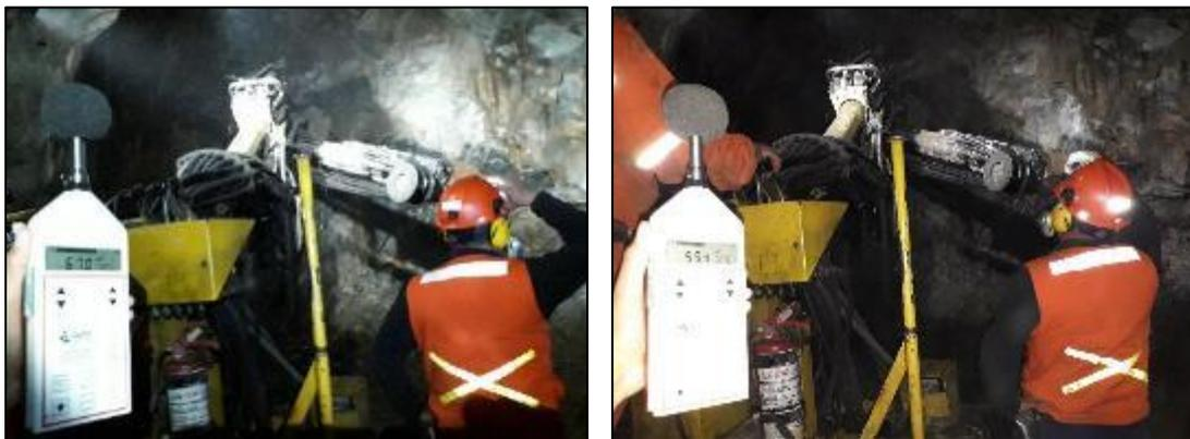
*Medición de ruido en la actividad de “Perforación y colocación de cable bolting”- Veta Encuentro - Cámara – Nivel 2566. Enero 2023. Fuente: Elaboración propia.*
