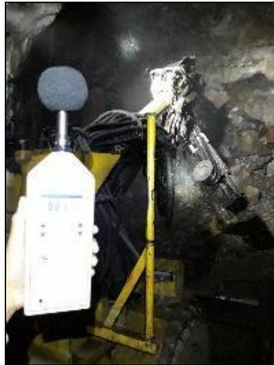
Medición de ruido en la actividad de “Perforación y colocación pernos helicoidales lechados”-Veta Encuentro - Nivel 2600. Enero 2023. Fuente: Elaboración propia.
