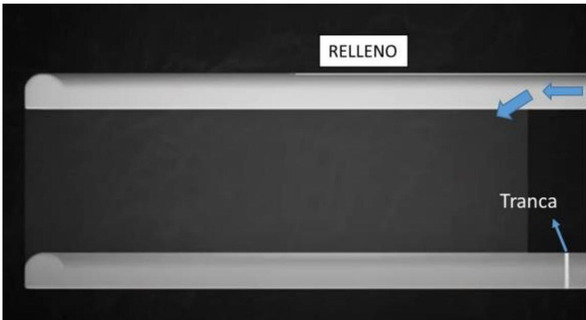
6. Una vez rellena la cámara, el nivel superior sirve de piso para continuar explotando la veta en forma ascendente.
