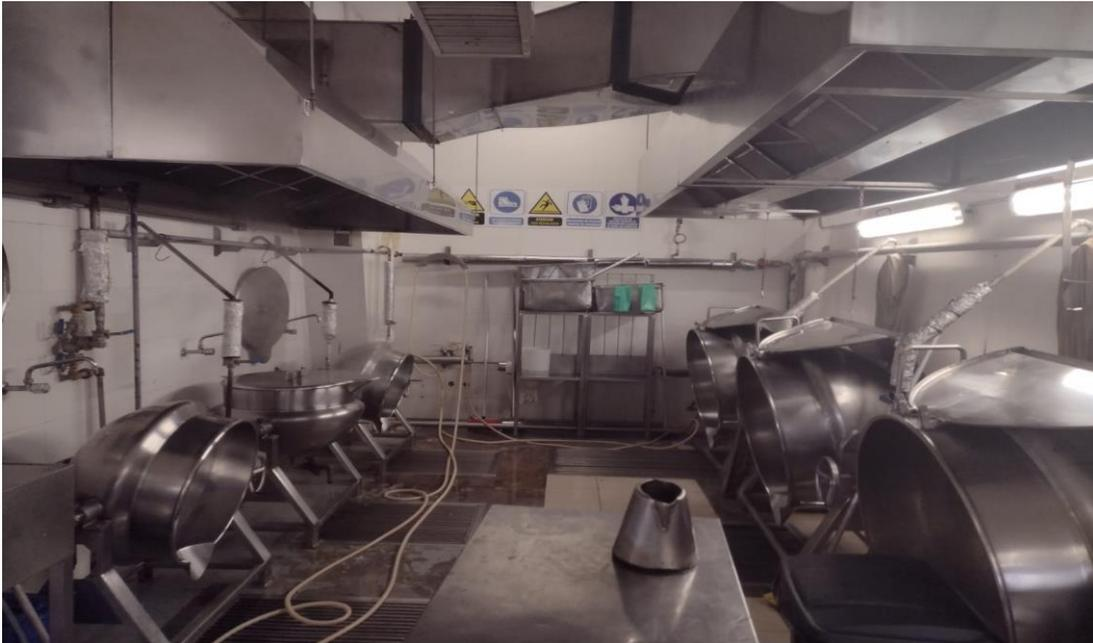
LAS MARMITAS son recipientes cilíndricos con agitación, calentamiento, y sistema de volteo, utilizados para la preparación de los alimentos tales como: Salsas, guisos, sopas, mermeladas, etc. Existen distintos tipos de marmitas dependiendo del proceso de preparación y características requeridas.
