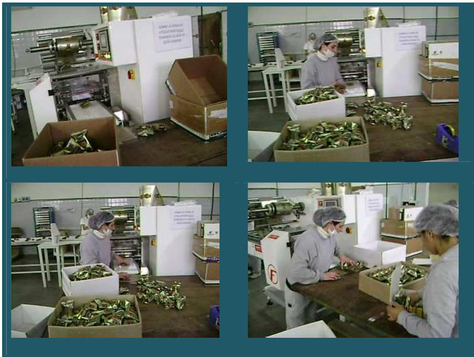
**Figura 2.18 Recepción de los alfajores que salen de la máquina envasadora**
