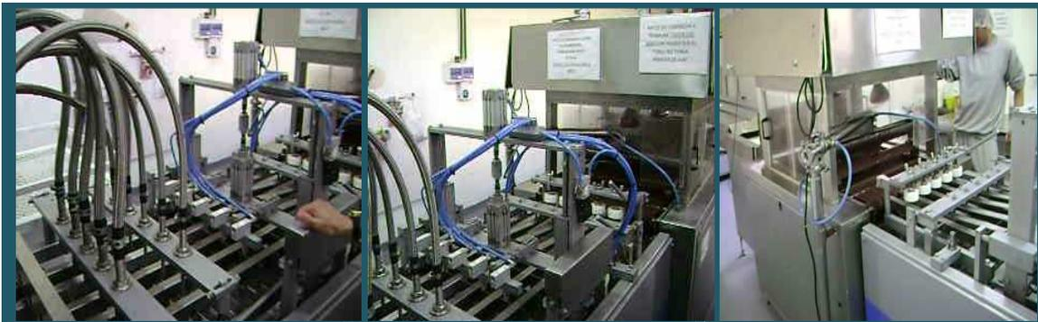
Figura 3.8 Sección de la máquina dosificadora donde se realiza el armado de los alfajores
