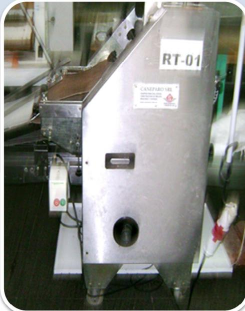
Los cables de conexión de la máquina galletera se encuentran sueltos y tirados en el piso.
