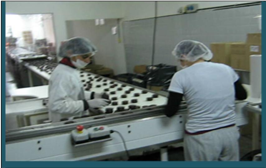
**Figura 3.11** Trabajadoras retirando alfajores de la cinta transportadora para luego ingresarlos en la máquina envasadora.
