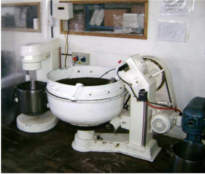
Figura 3.2 Separación inadecuada entre maquinas
