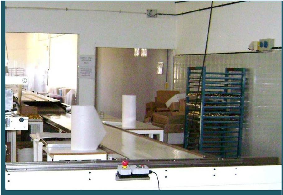
**Figura 3.13** Cintas transportadoras entre la salida del túnel de enfriamiento y la entrada a la máquina envasadora.
