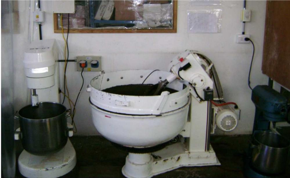
Figura 3.4 Separación inadecuada entre maquina batidora y amasadora
