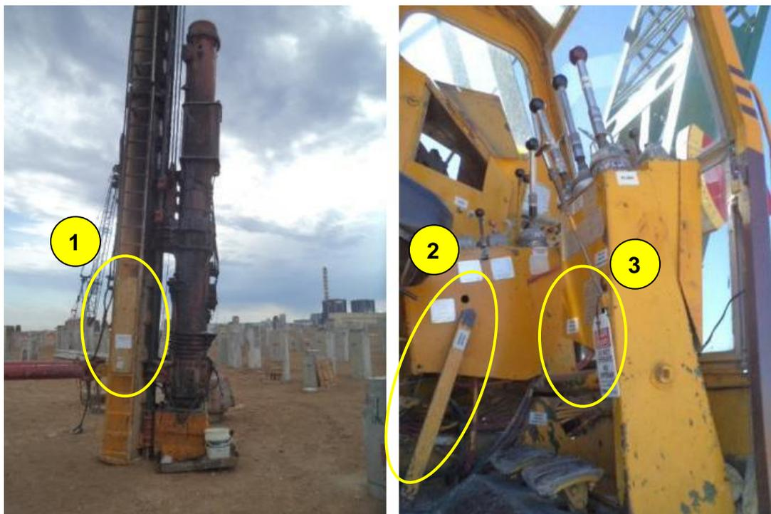
Figura 19 - Condición de pilotera detenida para mantenimiento. 1-Bloqueo de acceso a resbaladera, 2-Bloqueo de palanca embrague, 3- Bloqueo de mandos de pilotera.
