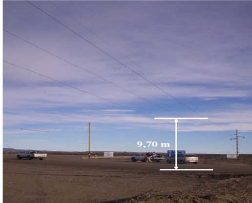
Grafico 7.6 Altura de la catenaria del cable
