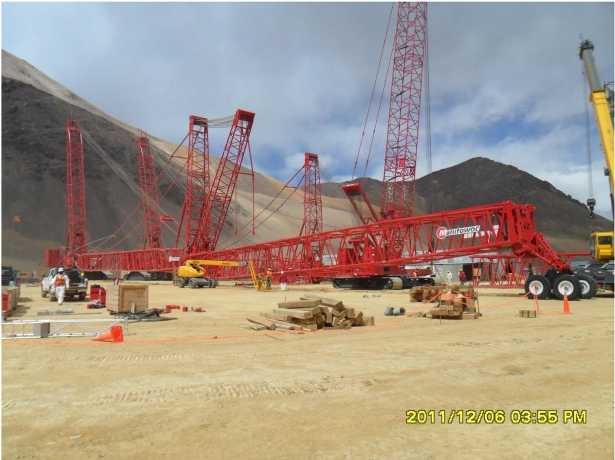
**Figura 2.31 – Armado de grúa móvil tipo oruga 600 TN**
