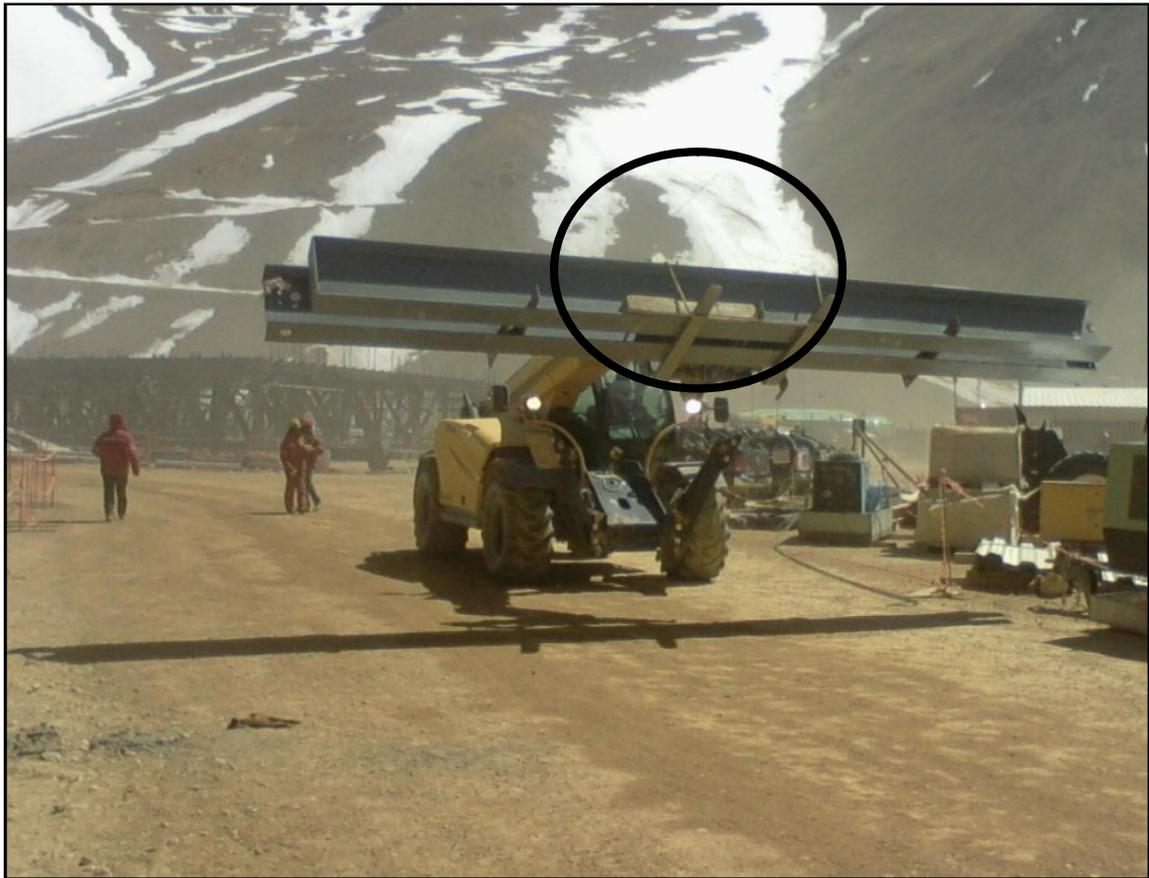
**Figura 2.21 – Carga sujeta mediante una soga**
