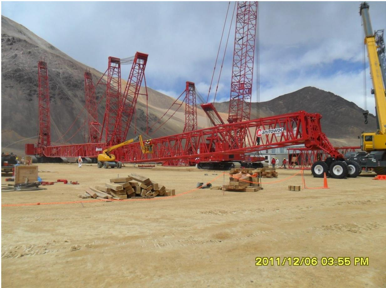
**Figura 2.32 – Armado de grúa móvil tipo oruga 600 TN**
