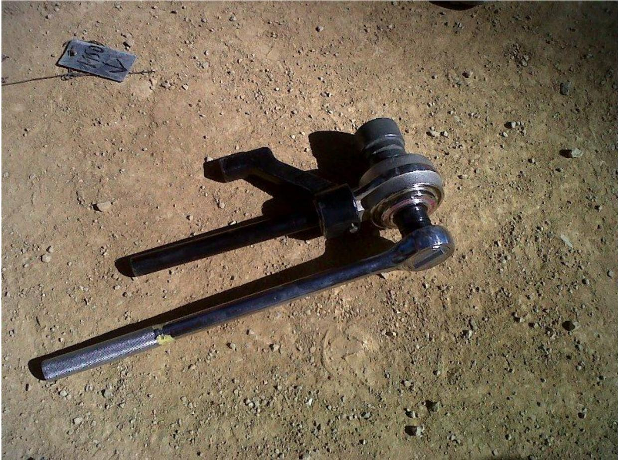
**Figura 2.19 - Torqueo de bulones. Llave de torque con multiplicador**
