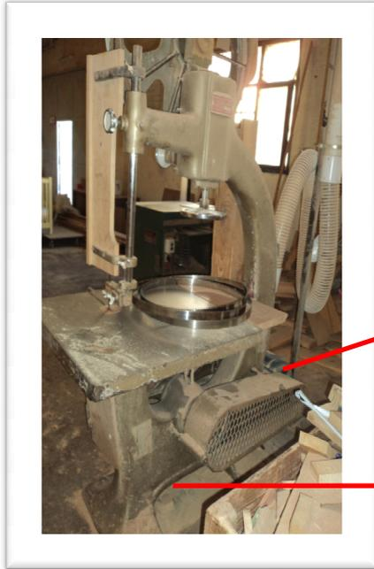
El motor de la maquina se encuentra muy cerca de restos de madera y con un poco de aserrín generando una condición insegura
