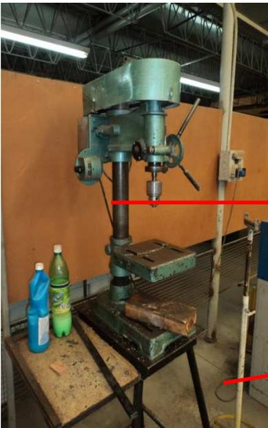
Cable que sale de la maquina queda totalmente colgado para conectar al tomacorriente produciendo condición insegura
