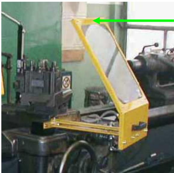
Protección móvil y orientable, a instalar en la parte frontal del carril derecho del torno. Realizada en chapa de acero y material plástico antichoques
