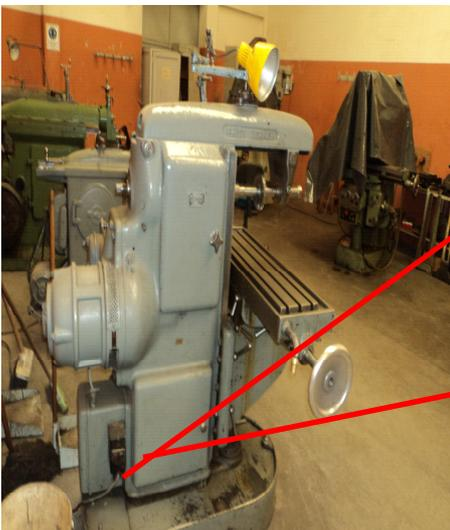
Cable de alimentación sale de la maquina y va al tomacorriente pasando por al lado de un lampazo con liquido. Riesgo de explosión.
