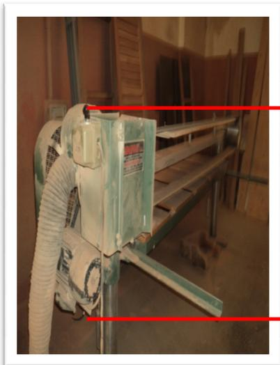
Interruptor de encendido de la maquina sin ningún tipo de bloqueo para evitar el accionamiento accidental.
