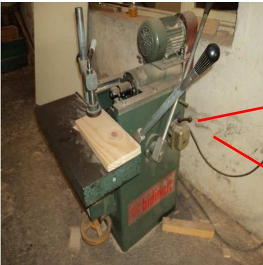
Interruptor de accionamiento sin señalización y bloqueo. Contiene aserrín encima del
