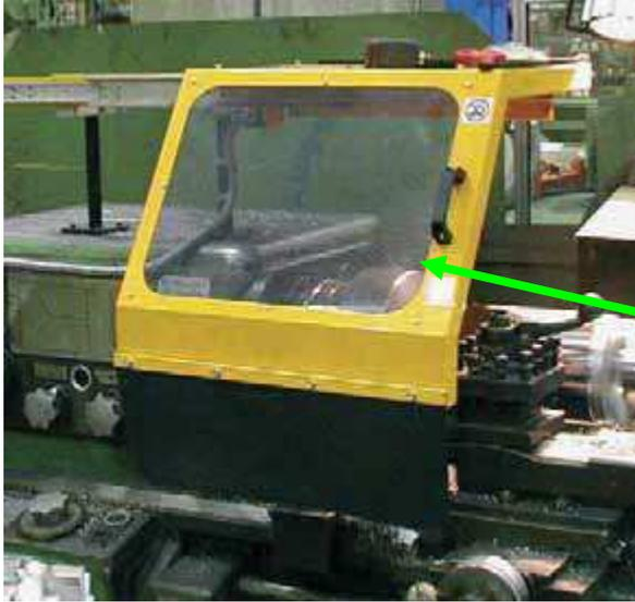
Protección corredera sobre guías de bolas para instalar en el cabezal del torno. Realizada de chapa de acero con pantalla de material plástico antichoque y microinterruptor de seguridad.
