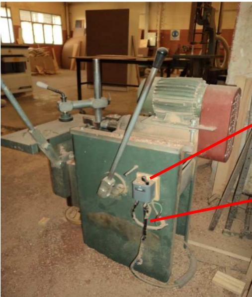
Interruptor de accionamiento sin señalización y bloqueo. Contiene aserrín encima del mismo.
