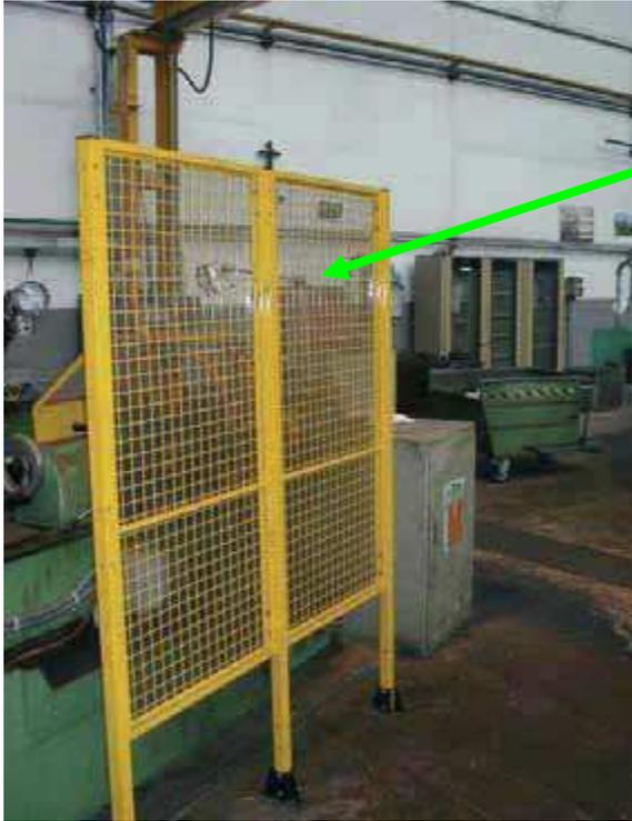
Protección para torno a instalar en la parte posterior de la maquina, compuesta de soportes fijados en el suelo y paneles a extracción rápida para facilitar las operaciones de limpieza de la máquina.
