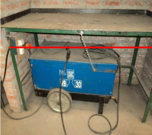
Soldadora eléctrica conectada correctamente la puesta a tierra
