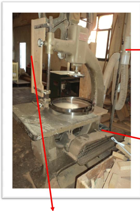
Se observa sistema de extracción de partículas a lado de la máquina para evacuar partículas al exterior.
