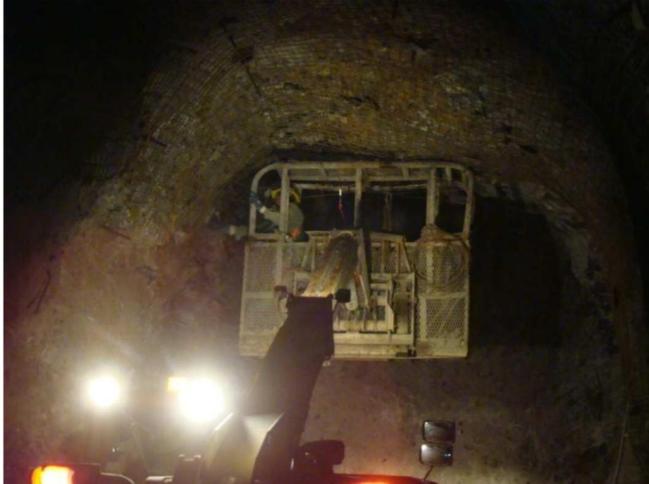
Foto N° 20 Operario inspeccionando si existen rocas sueltas para poder retirar la tuerca y planchuela
