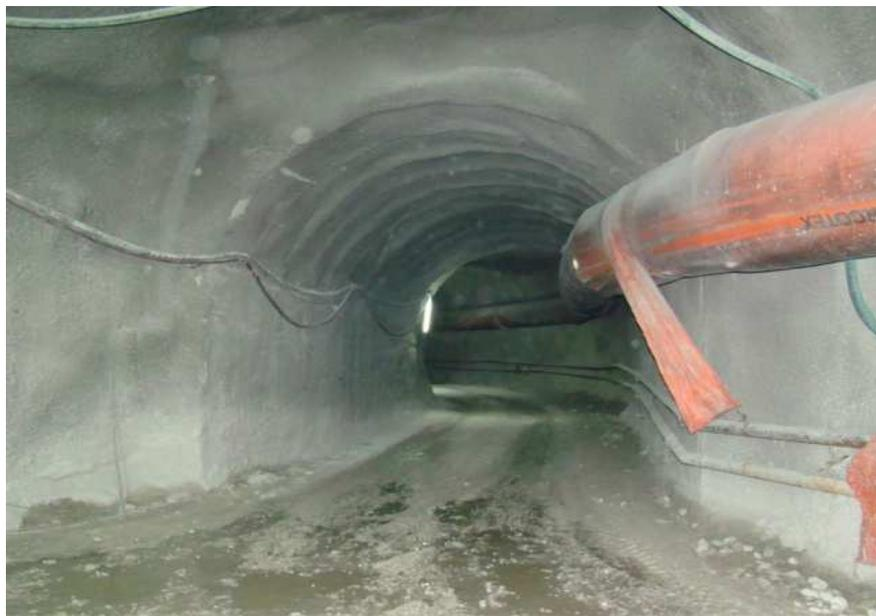
Foro N°47 Se Observa a la Izquierda cables eléctricos, Derecha cañería de agua y aire
