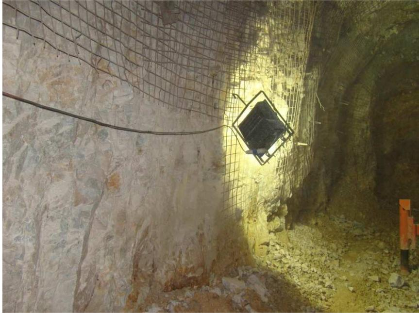
Foto N° 4 Frente de trabajo iluminado con lámpara Halógeno
