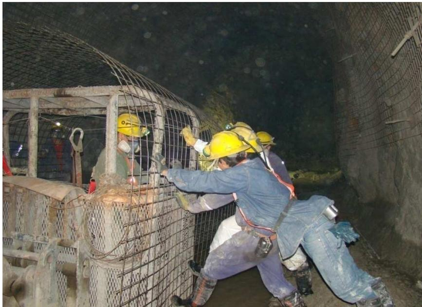
Foto N° 17 Se observa personal preparando malla para colocarla en el equipo de levante
