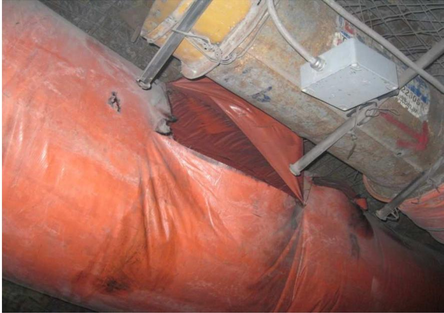
Foto N°38 Se observa la rotura de gran porte pierd e un caudal de aire aproximadamente de 22 m3/min.
