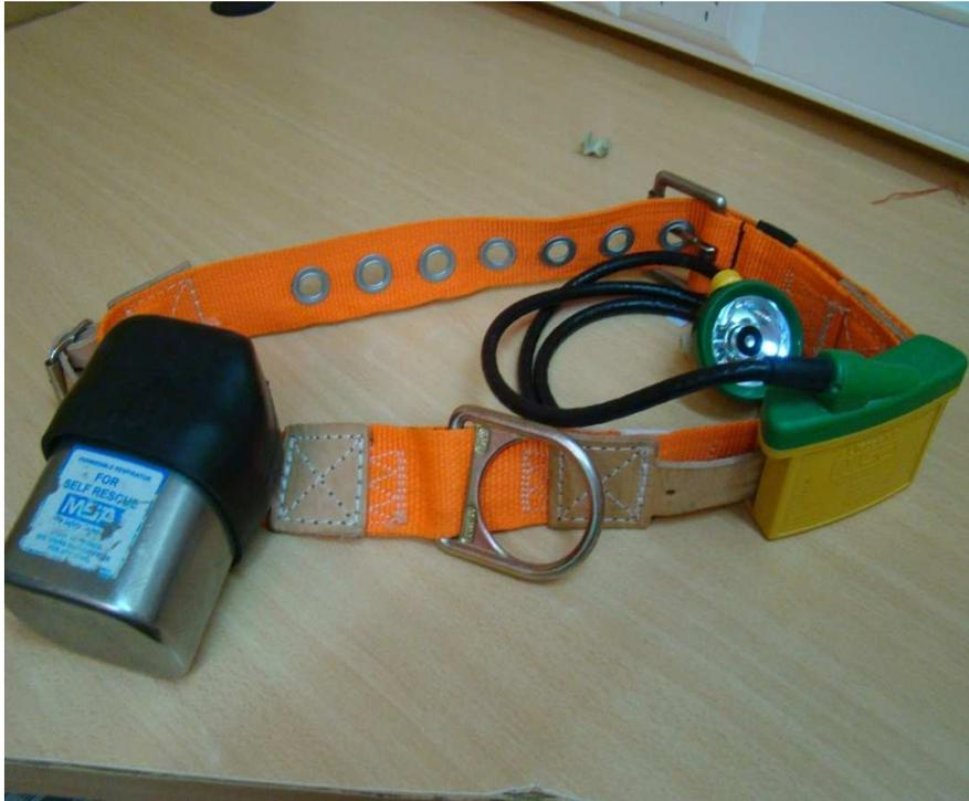
Foto N°50 Se Observa autoresc atador , lampara minera y cinturon
