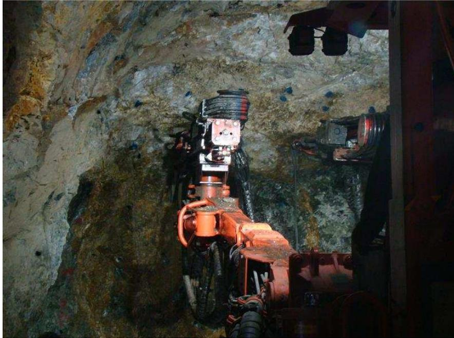
Foto N° 6 Equipo Jumbo realizando la perforación para los pernos
