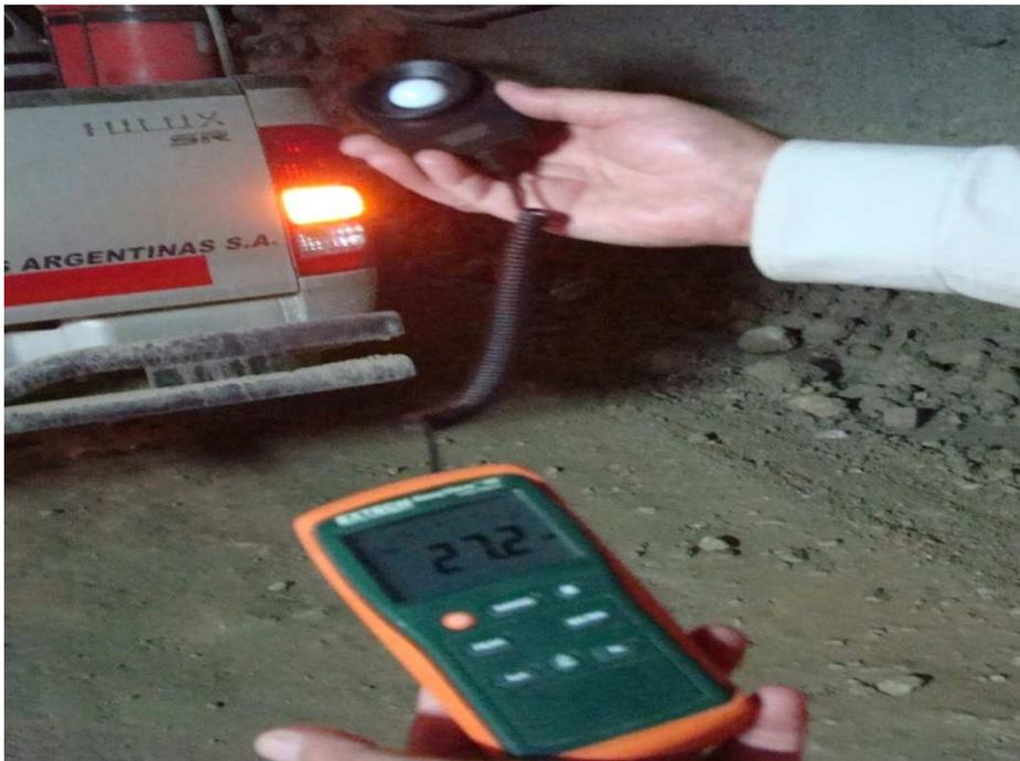
Foto N°31 La medición realizada en el sector con iluminación, que da el Valor de de 27,2 LUX.
