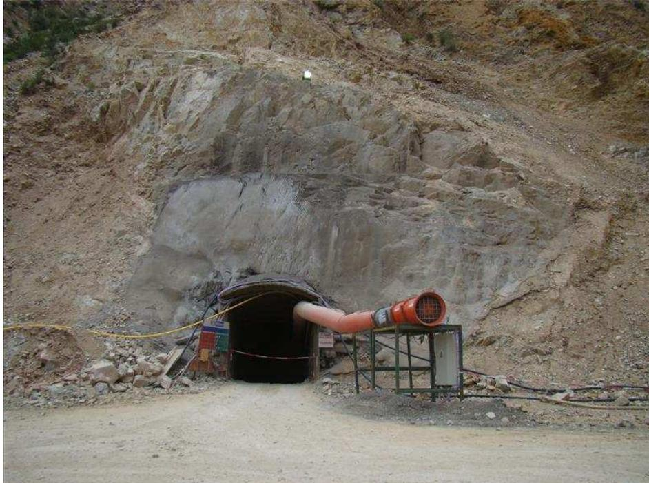
Foro N°35 Se observa la inyección de aire fresco a l interior de la mina con Ventilador Axiales, también se les llama ventiladores de hélice
