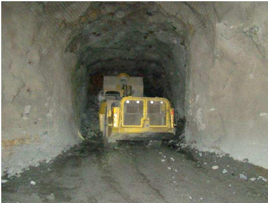
Foro N°44 Se observa cargando retirando la marina después de una voladura, produciendo polvo en suspensión y acumulación de monóxido
