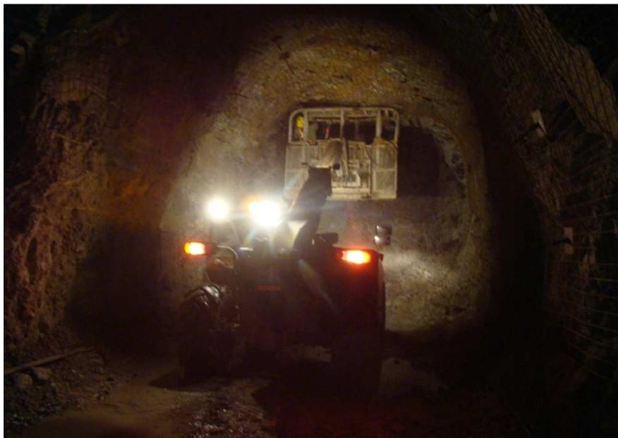
Foto N°3 Se observa tojeando con equipo de Levante
