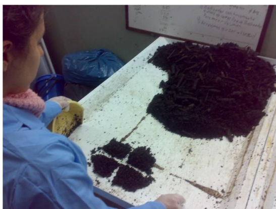
IMAGEN 29. Izq: Extrayendo una muestra del sustrato bajo tratamiento aeróbico mediante selección por cuarteo. Der: Instrumento digital, reactivos y recipientes utilizados para la determinación diaria del pH del sustrato bajo tratamiento aeróbico.
