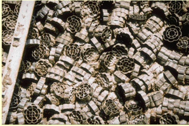
IMAGEN 9. Ejemplos de soportes inertes del diseño filtro anaeróbico. Fuente: CD-ROM "Biogas from waste and waste water treatment" Comisión Europea. Directorio General XVII para la Energía.
