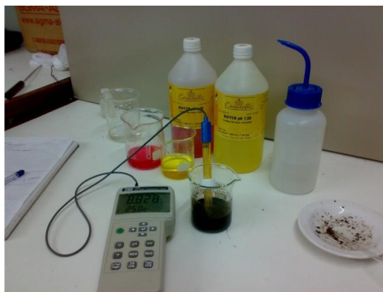
IMAGEN 29. Izq: Extrayendo una muestra del sustrato bajo tratamiento aeróbico mediante selección por cuarteo. Der: Instrumento digital, reactivos y recipientes utilizados para la determinación diaria del pH del sustrato bajo tratamiento aeróbico.
