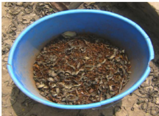
IMAGEN 7. Pequeños objetos de hierro oxidado, utilizados en la eliminación del ácido sulfhídrico. Fuente: Torres Guillén, D. y Arteaga Chávez, L. "Desarrollo de un Sistema de Biodigestores y Energías Limpias". Facultad de Ingeniería. Universidad Nacional de Lima, Perú.
