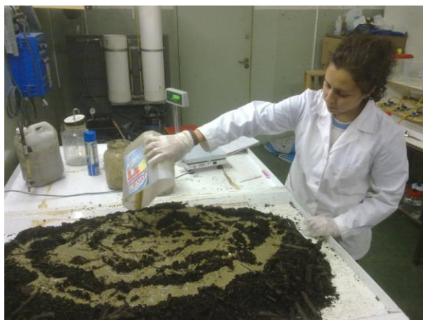
IMAGEN 26. Incorporación del lodo mezcla al sustrato semi-compostado de yerba mate residual+chip de poda
