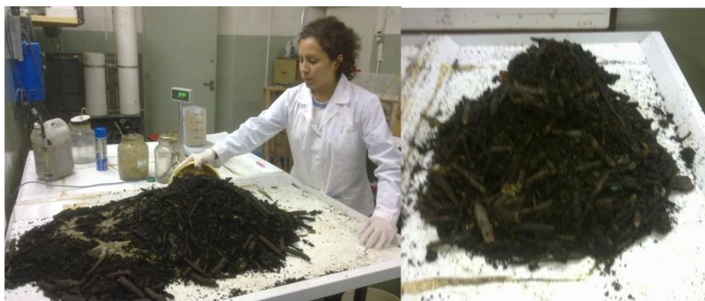
IMAGEN 27. Izq: Mezclando (sobre la plataforma de compostaje) el sustrato a tratar aeróbicamente: lodos + yerba mate semi-compostada + chip de poda. Der: pila armada luego de mezclar el sustrato.
