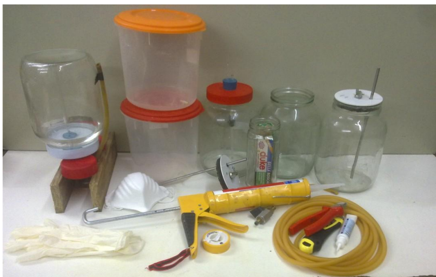
IMAGEN 19. Materiales, herramientas y accesorios para el armado del sistema de tratamiento biológico anaeróbico. En los extremos los biodigestores y al centro los gasómetros y los cierres hidráulicos; los primeros receptores del agua desplazada por el biogás desde los segundos.
