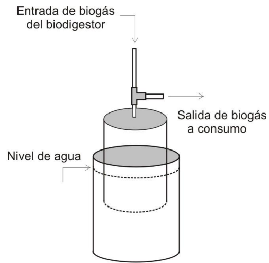
IMAGEN 10. Fotografía y esquema de un gasómetro tipo campana móvil separado del biodigestor. Fuente: "Manual de instalación de un biodigestor familiar tipo manga para zonas alto-andinas". Universidad Politécnica de Cataluña.
