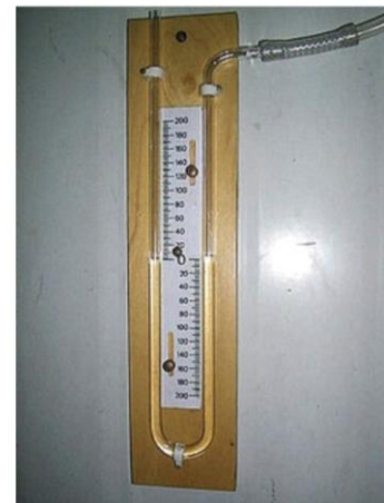
IMAGEN 8. Manómetro de agua en forma de U. Fuente: José Antonio Guardado Chacón “Tecnología del biogás”. Unión Nacional de Arquitectos e Ingenieros de la Construcción de Cuba.
