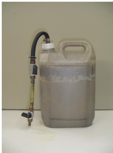
IMAGEN 25. Biodigestor que ofició de testigo del tratamiento anaeróbico durante todo el periodo de proceso.
