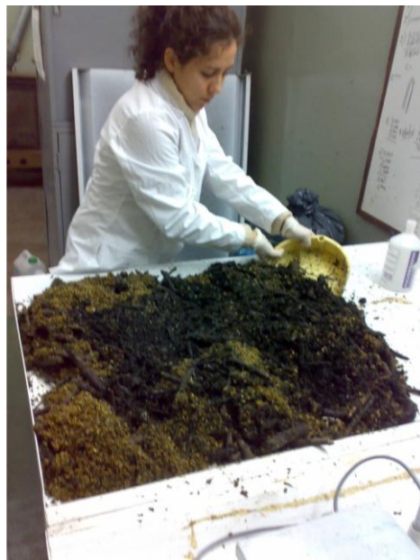
IMAGEN 23. Mezcla manual de yerba mate residual recientemente incorporada al sustrato de la pila en proceso de compostaje.
