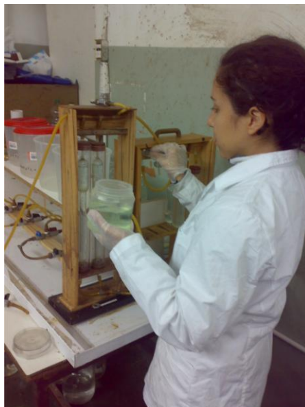
IMAGEN 28. Medición de volumen de biogás generado.
