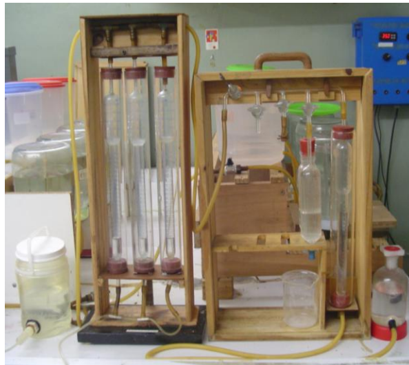
IMAGEN 20. Izq: Sistema de medición de volumen de biogás y de dióxido de carbono. Der: Aparato ORSAT.
