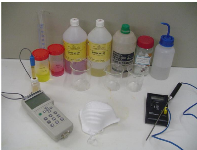
IMAGEN 21. Instrumental y reactivos de laboratorio utilizados en el control de la experiencia. Izq. pHmetro y buffers de calibración. Der. Termómetro y reactivos (HCl y KOH).
