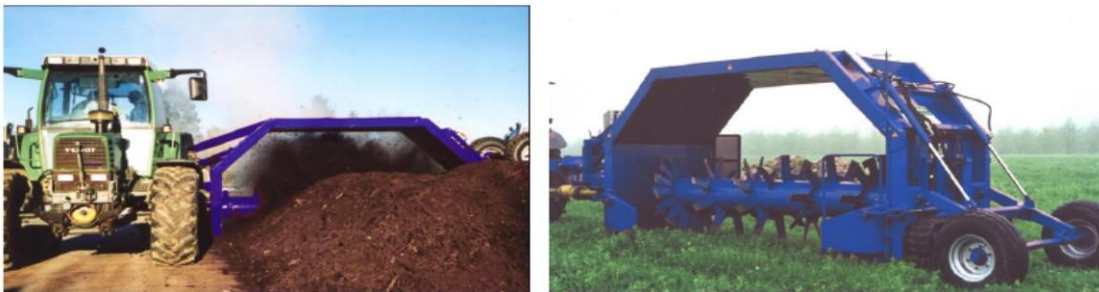
IMAGEN 17. Volteadora a la toma de fuerza del tractor. Fuente: Corleto B. y Menna M., 2008
