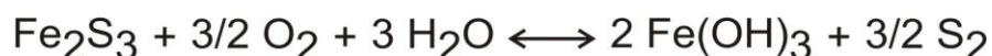
FIGURA 17. Reacciones químicas de eliminación de ácido sulfhídrico. Fuente: Manual para la producción de biogás (2003). Hilbert J. INTA-Castelar
