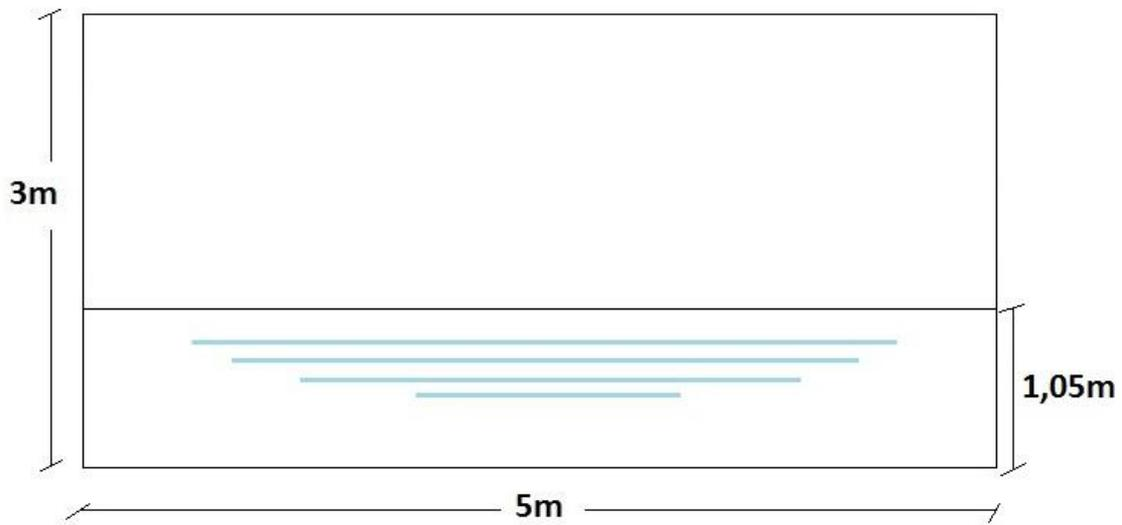
Croquis de la sección del canal rectangular funcionando a  $\frac{1}{2}$  del caudal máximo.
