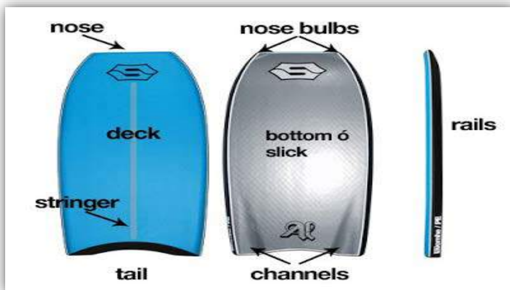
Imagen N°5: Partes de la tabla
