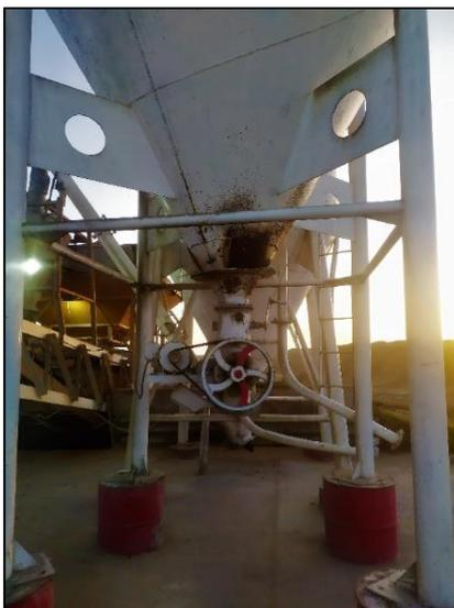
*Imagen N°: 3 Atrapamiento por partes móviles. Mecanismo de extracción de cemento.*
