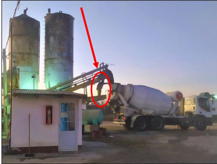
*Imagen N°: 1 Riesgo de caída a distinto nivel. Persona verificando cantidad de agua en mezcla.*
