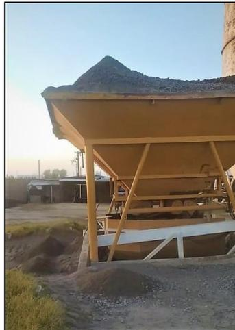
*Imagen N°: 9 Desniveles de suelo, montículos, próximos a tolvas de carga de áridos.*
