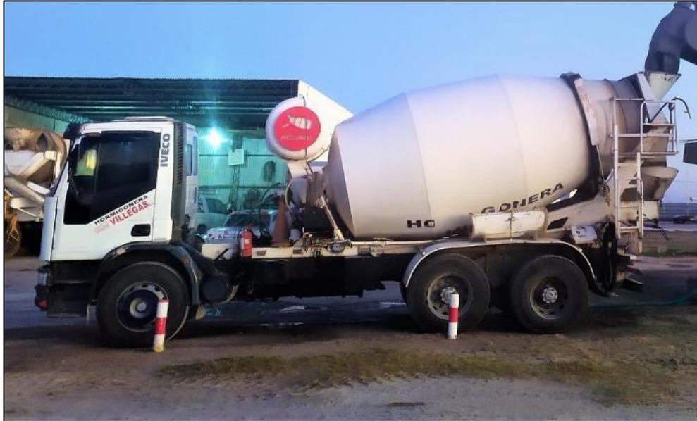
*Imagen N°: 46 Camión Mixer o Mezclador.*
