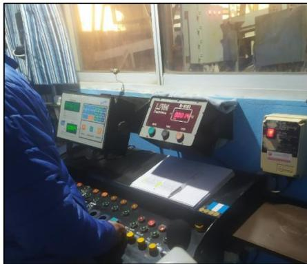
*Imagen N°: 5 Panel de control de planta dosificadora.*
