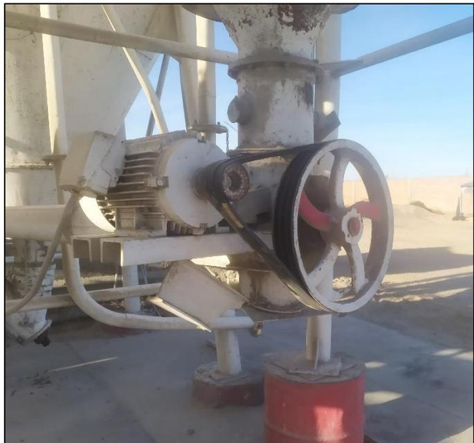
**Imagen N°: 25** Motor p/ transporte de cemento.
