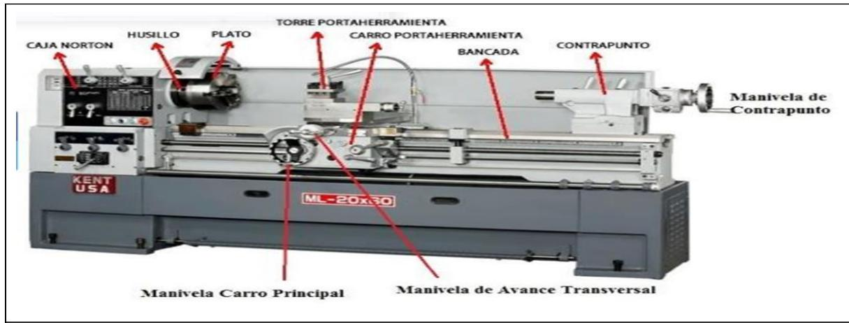
**Nota:** Vista frontal de un torno paralelo. Adaptado de partes de un torno [Imagen] Por areatecnologia, s.f., tomado de <https://www.areatecnologia.com/herramientas/torno.html>
