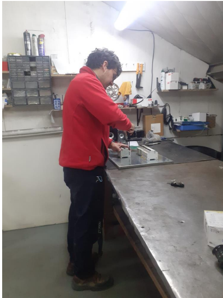
Operario demarcando contorno sobre placa metálica
