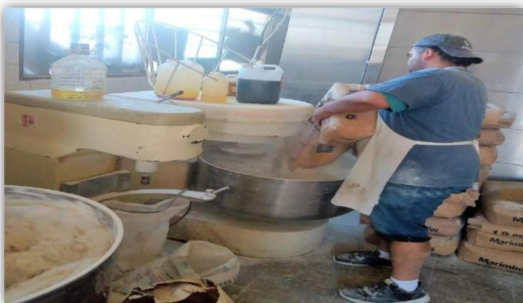
**c) Estirado de masa:** La masa es pasada por la máquina denominada Sobadora, ésta tiene como objetivo refinar y estirar la misma una determinada cantidad de veces, obteniendo láminas para el siguiente paso.
