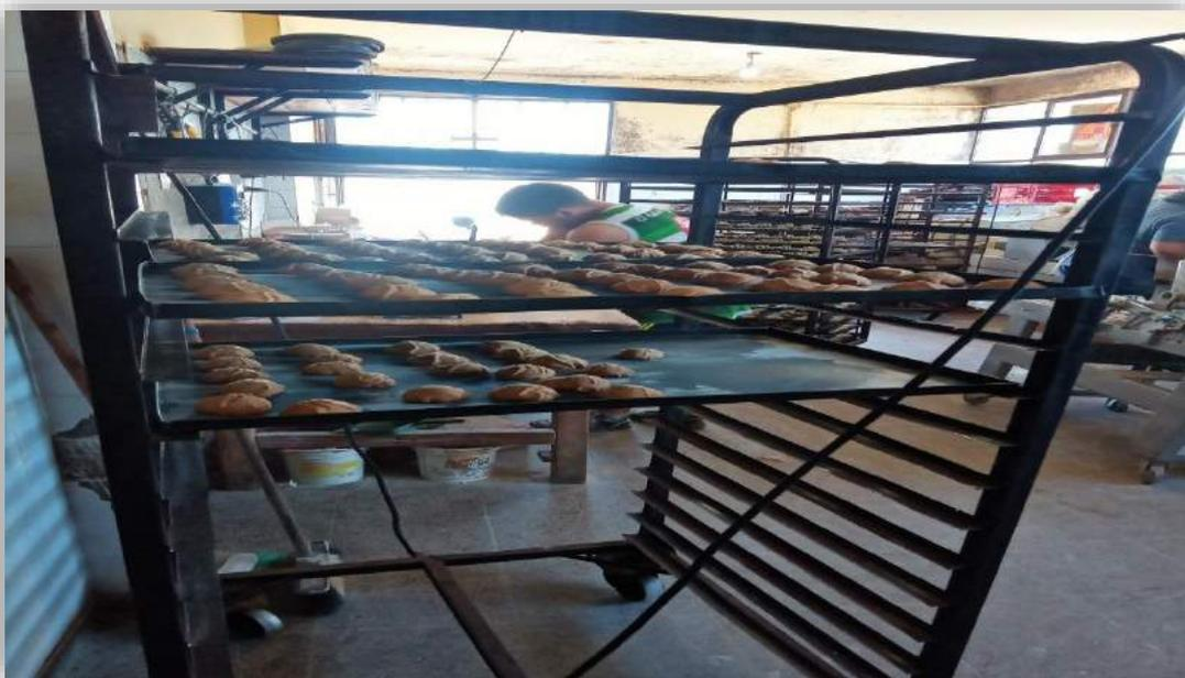
**g) Fermentación de las masas (pan):** Para que la levadura haga su efecto, es necesario que la masa se resguarde en un ambiente de temperatura y humedad adecuado. Es en el recinto conocido como “estufa” donde se produce ésta operación, antes de ser llevada al horno.
